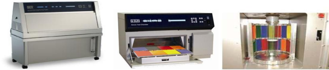
Şekil 1.11. QUV ve xenon arc yaşlandırma test cihazları [88].
