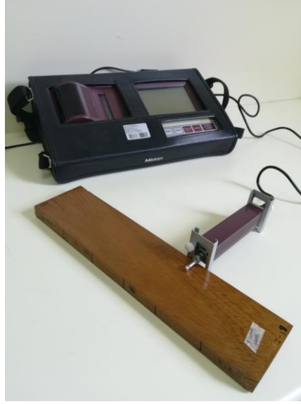
Şekil 2.14. Mitutoyo surfest SJ-301 cihazı ile pürüzlülük ölçümü [Foto Ulay].
