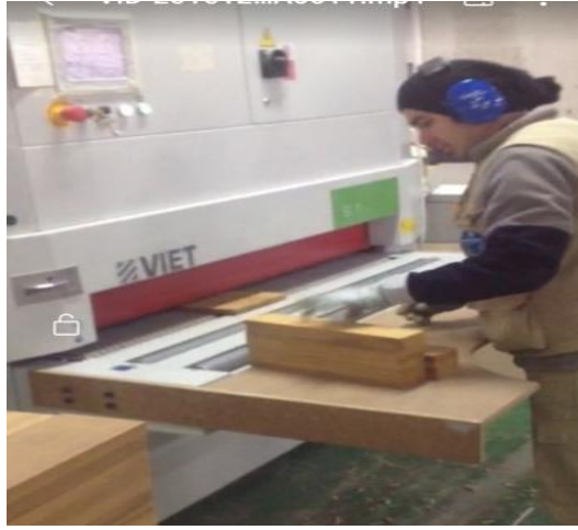
Şekil 2.4. Deney örneklerinin kalibre makinesinde zımparalanması [Foto Ulay].
