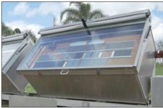
Şekil 1.7. Siyah kutu yaşlandırma platformu üzerine sıcaklık etkisi [79].
