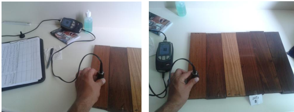
Şekil 2.7. PosiTector 200 cihazı ile kuru film kalınlığı ölçümü [Foto Ulay].
