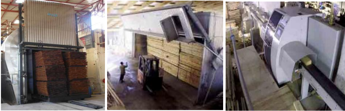
Şekil 1.22. Naswood firması ThermoWood'lu ahşap üretimi [114].
