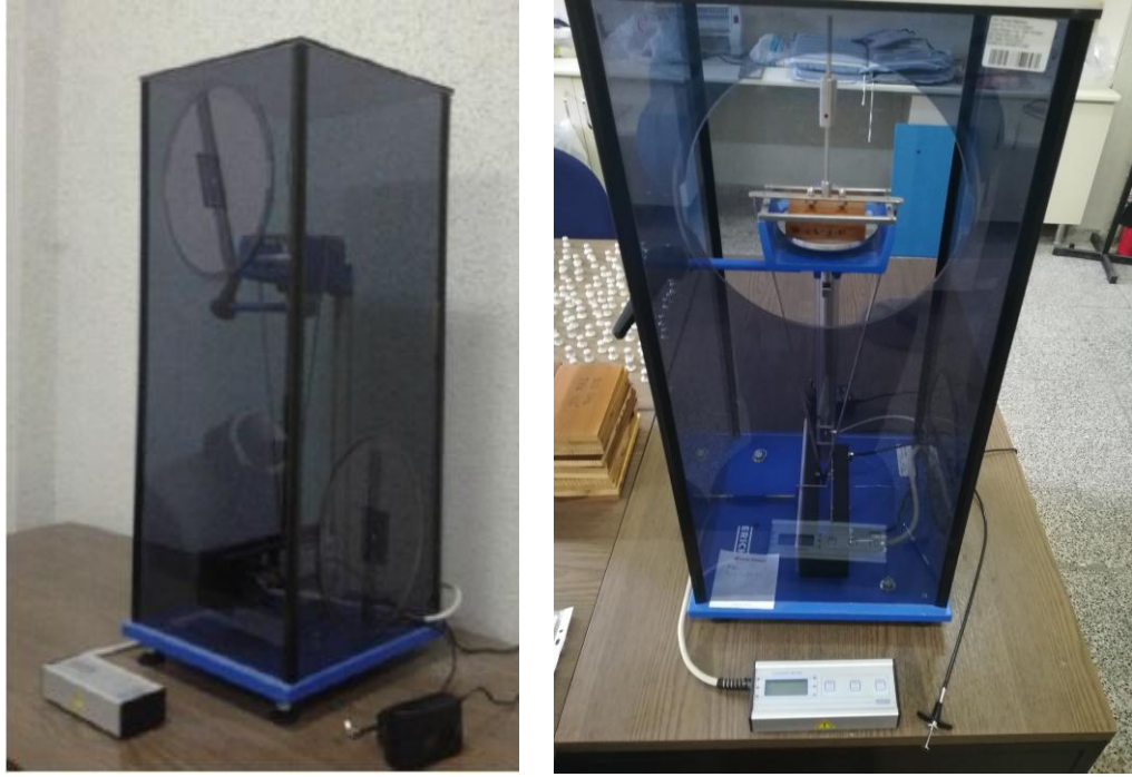
Şekil 2.15. Köning pandüllü salınımsal sertlik ölçüm test cihazı [Foto Ulay].
