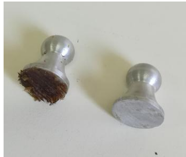
Şekil 2.21. Çekme işlemi sonrası dolly görünümü [Foto Ulay].
