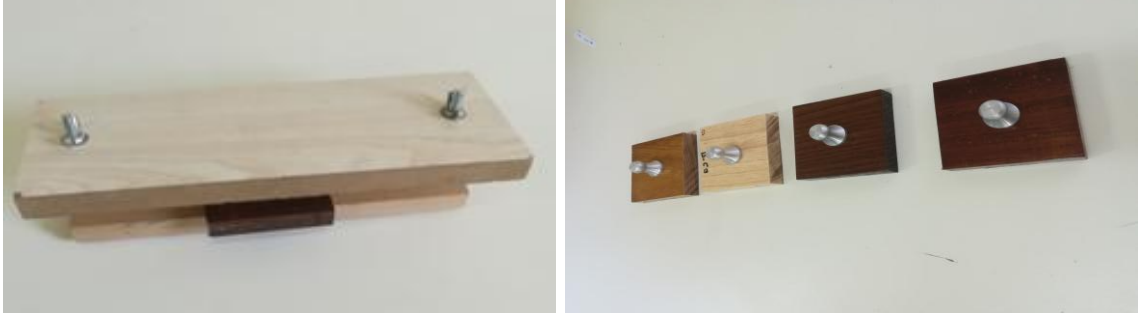
Şekil 2.19. Deney parçalarına kalıp yardımıyla dolly yapıştırılması [Foto Ulay].
