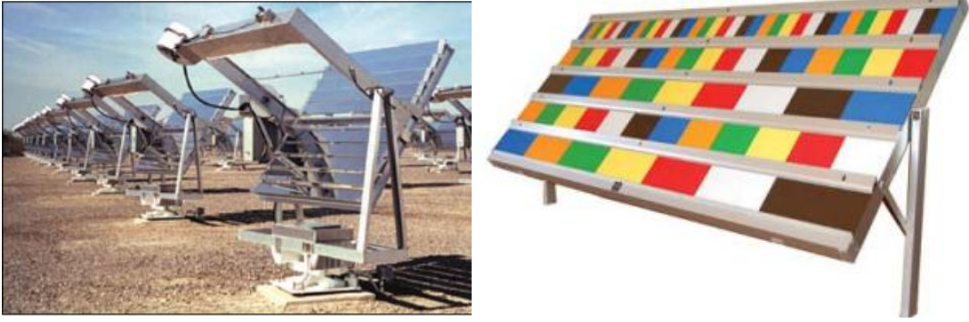
Şekil 1.8. Dış ortamda güneş ışınının ayna ile parça üzerine yansımaları [80].
