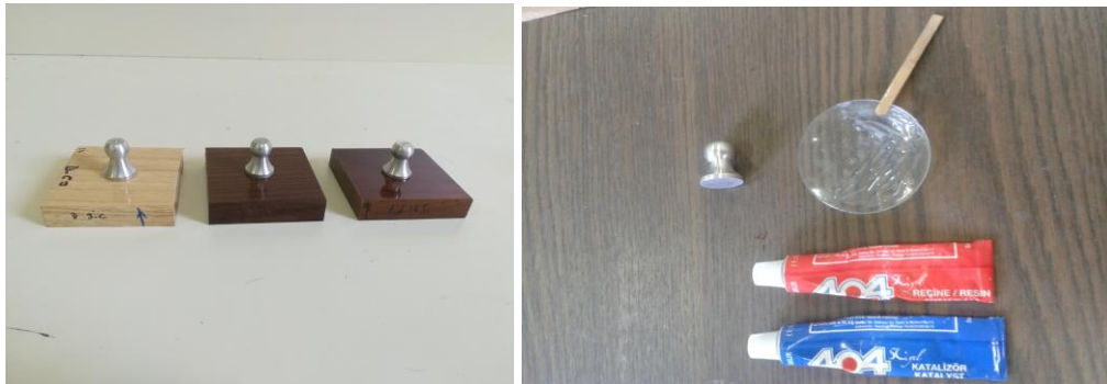
Şekil 2.18. Epoksi esaslı yapıştırıcı ve dolly hazırlanması [Foto Ulay].
