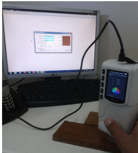
Şekil 2.8. Renk ölçüm cihazı ile renk ölçümü [Foto Ulay].
