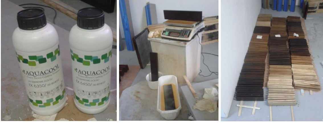
Şekil 2.5. Su bazlı UV koruyucu astar vernik uygulanması [Foto Ulay].
