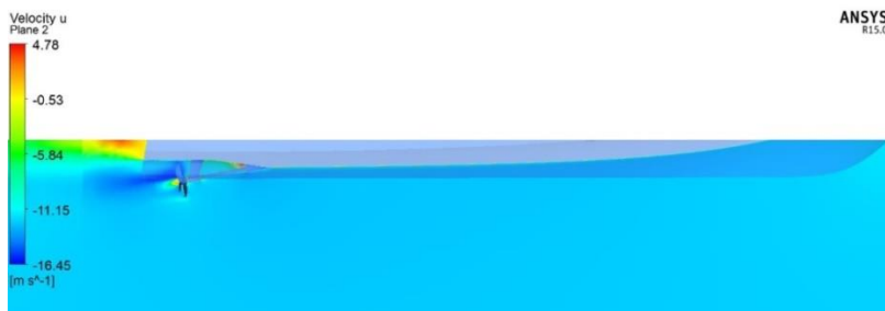
Şekil 6.43 : Pervane srkasında hız dağılımı ( J=0.9 ).
