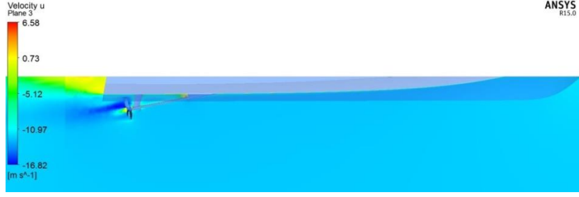
Şekil 6.22 : Pervane arkasında hız dağılımı ( J=0.9 ).
