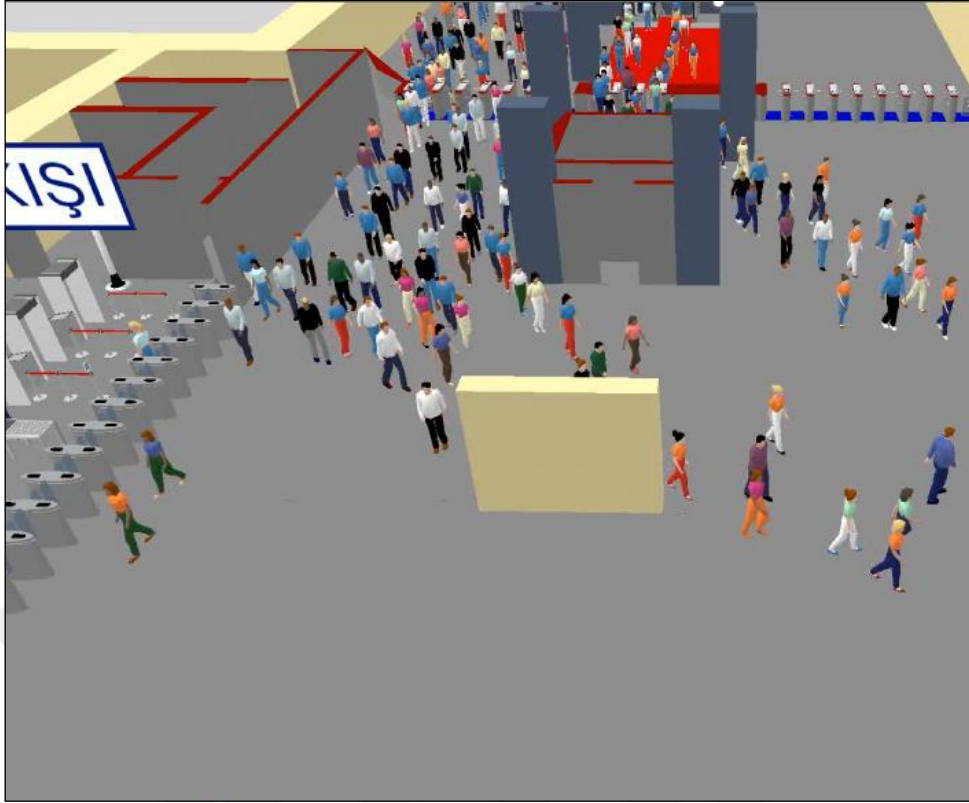
Şekil 5.29. İUFM simülasyon modelinde değişken yaya rotasının uygulanması
