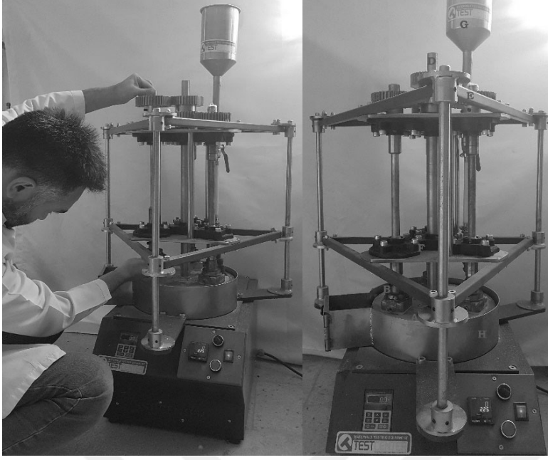
Şekil 3.3. ASTM C241 Aşınma test cihazı ve parçaları
