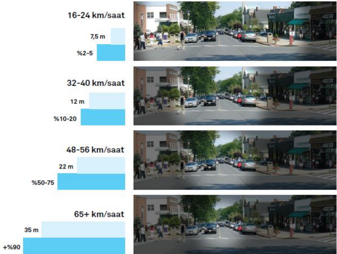
Şekil 1.4. Taşıt hızına göre görüş açısındaki değişim, hız dilimine göre durma mesafesi ve yayalar için can kaybı riski (Anonim 2016).
