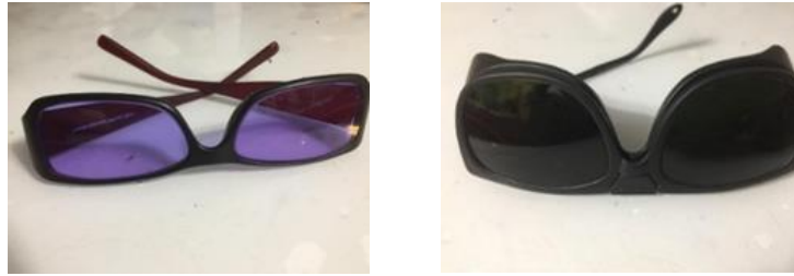
Görsel 2. 17. Didymium gözlük UV ve IR koruması yoktur ve Base Lens SB filtreli UV ve IR korumalı (Hale Albayrak Ersoy Arşivi)
