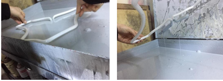
Görsel 2. 22. Elektrotların ve ısıması istenmeyen bölgelerin selülozik bir boya ile boyanması (Hale Albayrak Ersoy arşivi)
