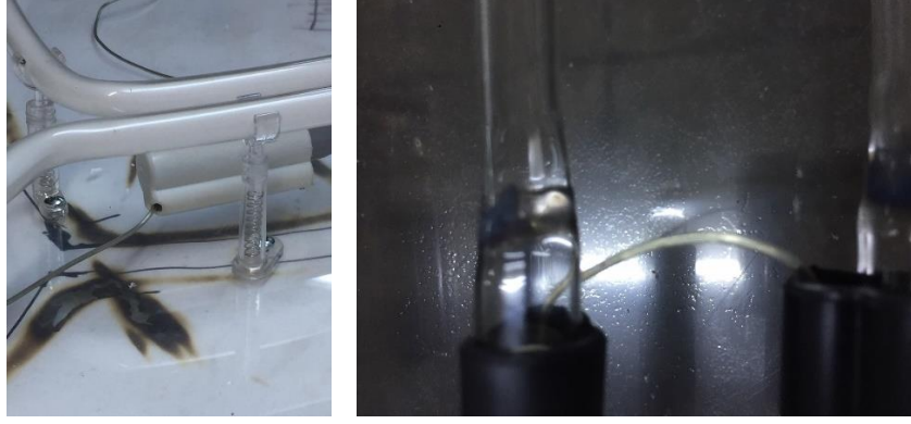
Görsel 2. 28. Elektrotlar birbirine bağlanıp kapüşonları takılır ve trafoya bağlanır. (Hale Albayrak Ersoy)
