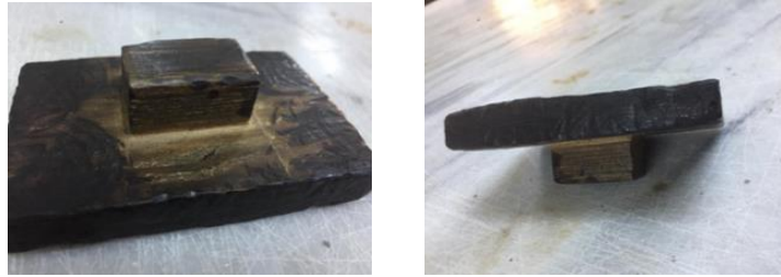
Görsel 2. 6 Büküm yapılmış cam tüpün zemin paraleline oturması için kullanılan takoz (Hale Albayrak Ersoy arşivi)
