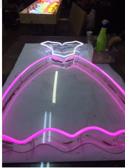
Görsel 2. 29. Tüm aşamaları tamamlanmış neon cam tüpler (Hale Albayrak Ersoy)
