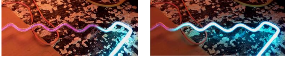
Görsel 1. 7. Soluk mor, argon gazının kendi başına ışıdığı renktir; cıva buharı tüp boyunca ilerledikçe daha yoğun mavi ortaya çıkar. ( https://brase.design/projects/neon-fundamentals , 2024)
