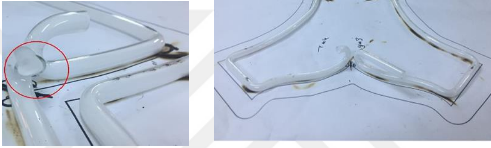
Görsel 2. 9. Bükümü tamamlanmış, elektrot bağlantı noktaları belirlenmiş tasarım (Hale Albayrak Ersoy arşivi)
