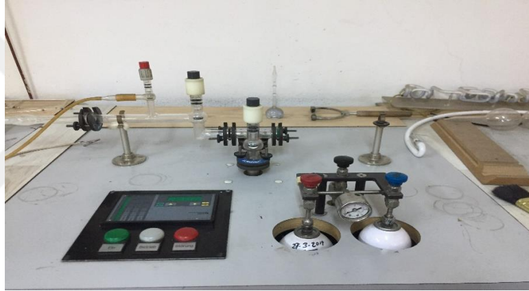
Görsel 2. 21. Bombardıman Makinası (manifold)kırmızı tüp neon, mavi tüp argon (Hale Albayrak Ersoy arşivi)
