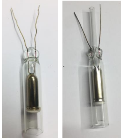
Grsel 2. 18. Elektrotlar diři(kr) ve erkek (Vakum ve gaz basamak iin takılan) elektrotlar
