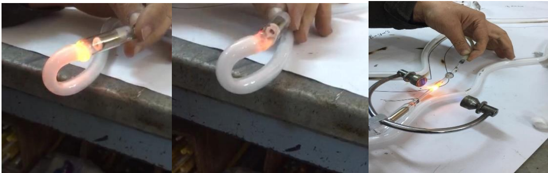
Grsel 2. 19. Kr elektrotun ve erkek elektrotun cam tpe montajı (Hale Albayrak Ersoy arřivi)
