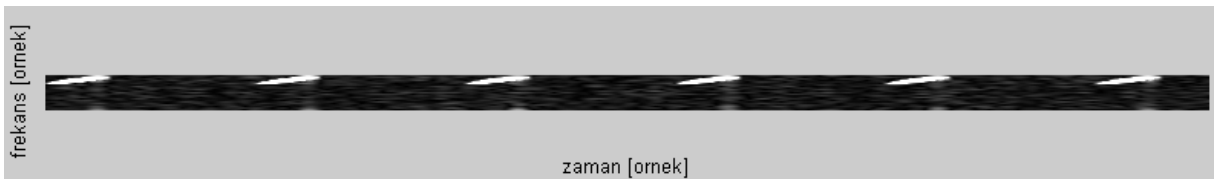
Şekil 5.5 Çörp tipi boğucu işaretin aralıklarla karıştığı bir DS-YS haberleşme sisteminde alıcıya gelen işaretin KSFD'si.
