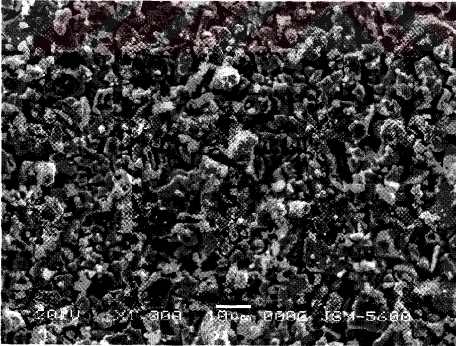
Şekil 42. Katıhal tepkime yöntemi ile üretilen YBa 2 Cu 2.7 Yb 0.3 O y numunesinin SEM fotoğrafı
