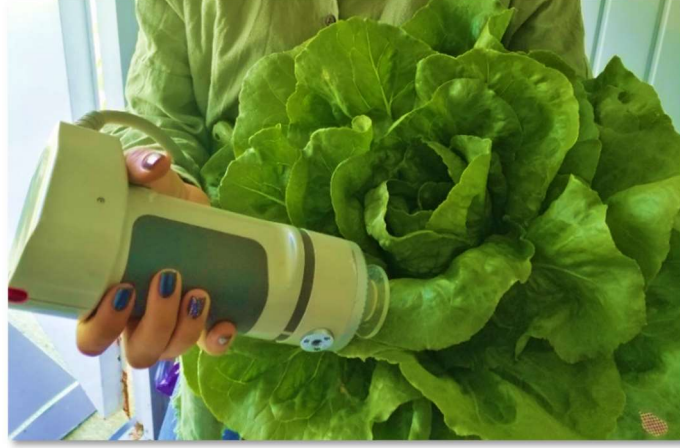
Şekil 3.12. Minolta Chromometre ile Yedikule marul genotiplerinde yaprak rengi ölçümü
