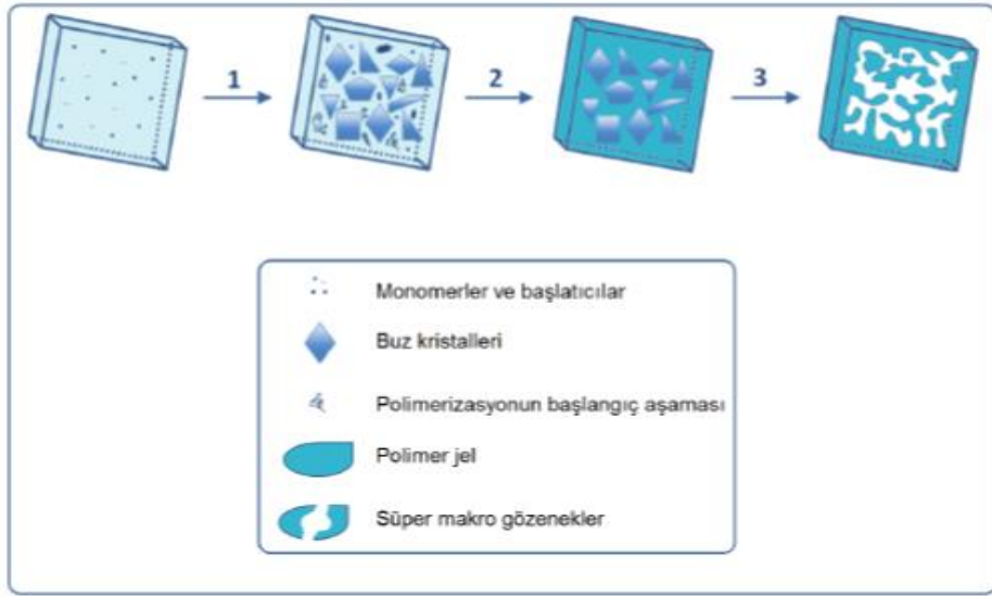
Şekil 3.4. Kriyojel üretim gösterimi (1: Donma, 2: Polimerleşme, 3: Erime) [34].
