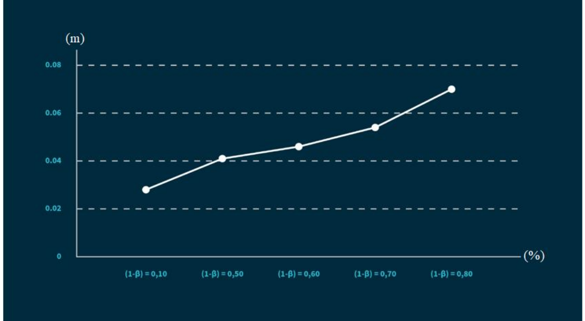
Şekil 4. 39. İlk kaplama aşaması ile Deconfinement (1-β) değeri ilişkisi grafiği
