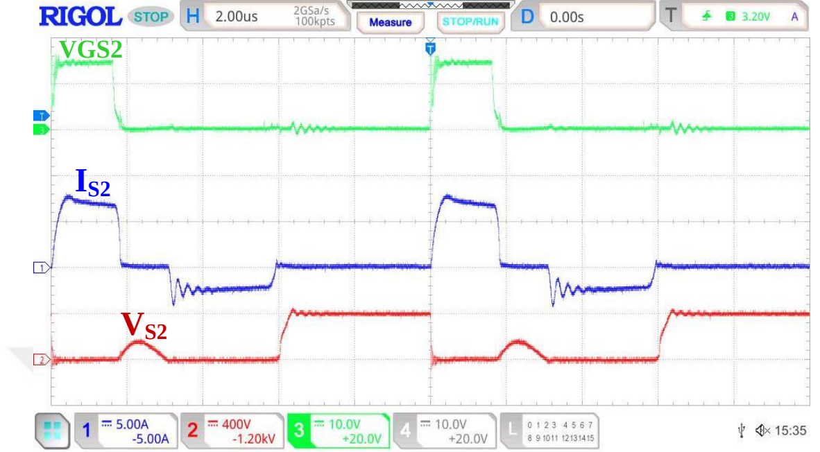
Şekil 5. 14. S 2 yardımcı anahtarına ait kontrol sinyali ile akım ve gerilim dalga şekilleri
