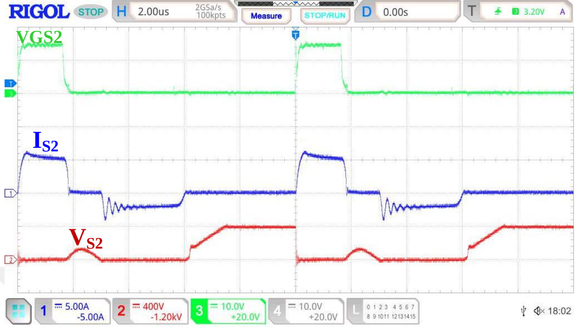
Şekil 5. 20. 50 W gücünde S_2 yardımcı anahtarının kontrol sinyali ile akım ve gerilim dalga şekilleri
