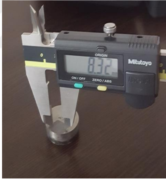
Şekil 5-10. İş parçası ve takım ucu aralığının 0,90 mm olduğu durumda ~6 mm olması gereken işleme alanı çapı
