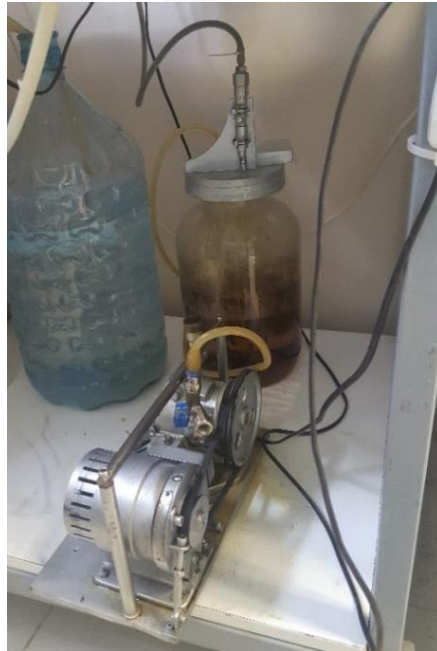
Şekil 4-6. Vakum pompası ve kirli elektrolit toplama sistemi
