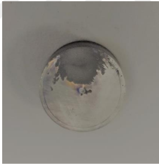
Şekil 5-11. 50 °C elektrolit sıcaklığı ile elde edilen Ti6Al4V işlemesi
