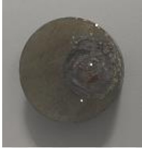
Şekil 5-23. NaCl-NaHCO 3 çözeltisiyle işlenmiş Ti6Al4V yüzeyi
