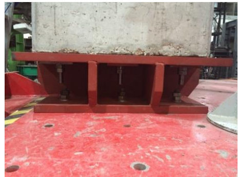
Şekil 3.42 : Soket temel ile sarsma masasının bağlantısı.
