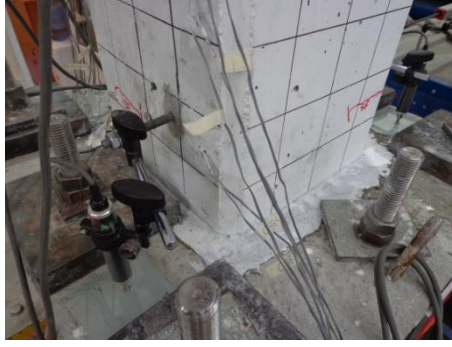
Şekil 3.102 : Kolon alt ucuna yerleştirilen yerdeğiştirme ölçerler (Sönümleyicili birleşim).
