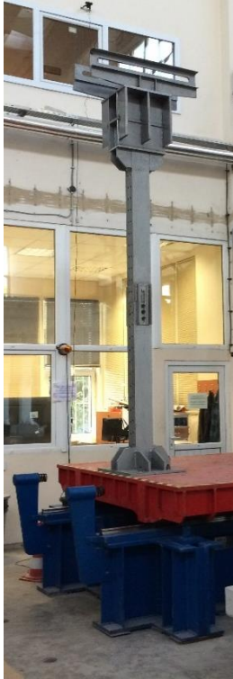
Şekil 3.26 : Deney sisteminde kayıcı mesnet olarak kullanılan çelik kolon.
