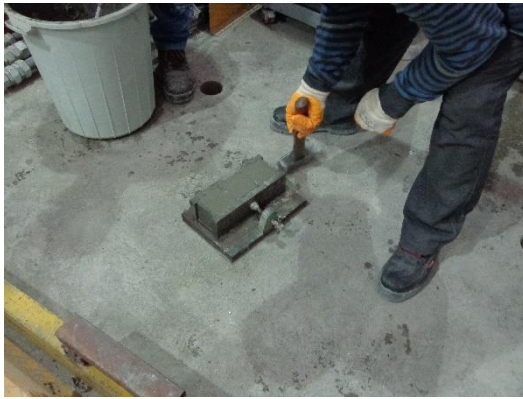
Şekil 3.24 : Harç numunelerinin alınması ve basınç deneyinin yapılması.
