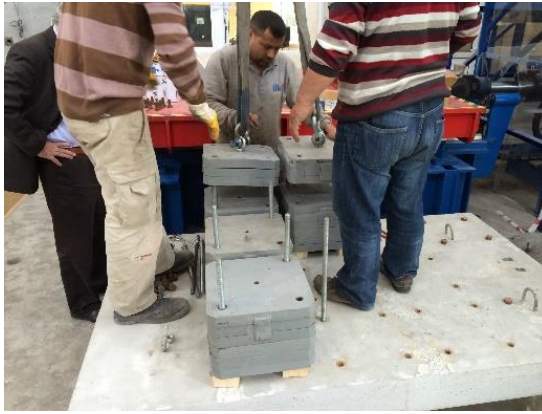
Şekil 3.41 : İlave kütlelerin kiriş tabliyesine bağlantısı.
