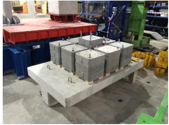
Şekil 3.41 : İlave kütlelerin kiriş tabliyesine bağlantısı.
