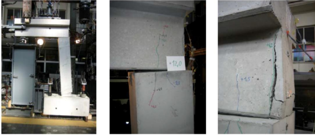
Şekil 3.3 : Kolonda meydana gelen dönme ve kiriş yüzünde oluşan hasarlar.
