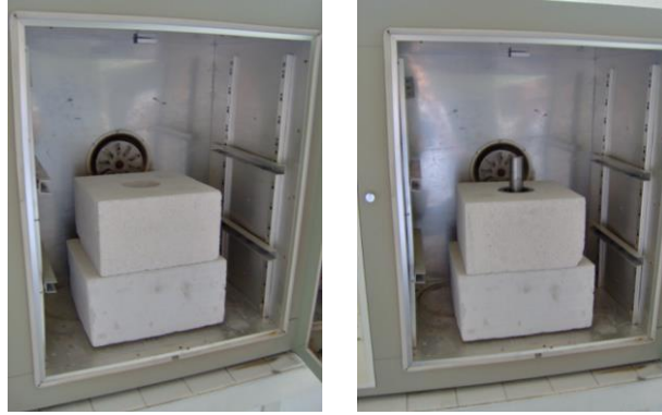
Şekil 2.49 : Gazbeton blokların ve sönümleyici parçalarının ön ısıtılması.
