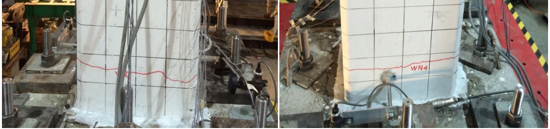
Şekil 3.57 : WN4 testi sonrasında kolonda bulunan eğilme çatlak.
