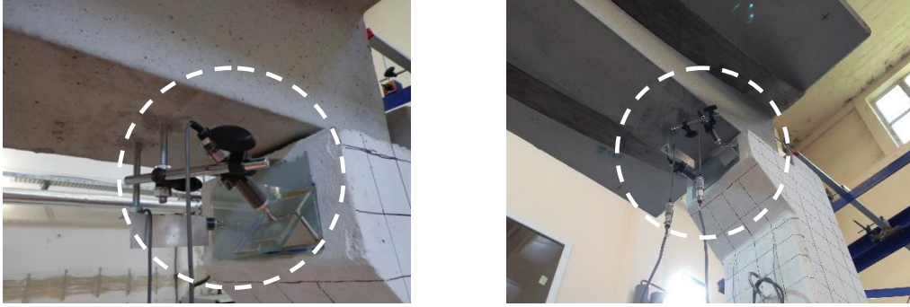
Şekil 3.79 : Kiriş-kolon birleşim bölgesine yerleştirilen yerdeğiştirme ölçerler (Yalın birleşim).
