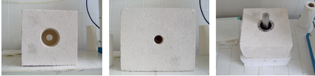
Şekil 2.48 : KES'in üretiminde kullanılan gazbeton bloklar.
