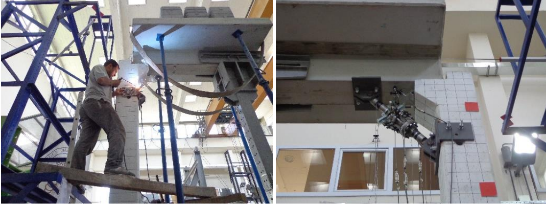
Şekil 3.47 : Bağlantı levhalarının ve KES'in montajı.
