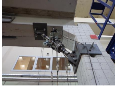
Şekil 3.107 : Kiriş-kolon birleşim bölgesine yerleştirilen yerdeğiştirme ölçerler (Sönümleyicili birleşim).
