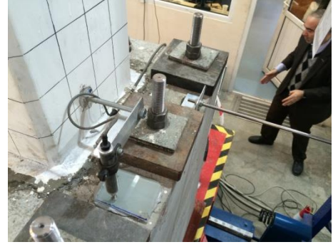
Şekil 3.74 : Kolon alt ucuna yerleştirilen yerdeğiştirme ölçerler (Yalın birleşim).
