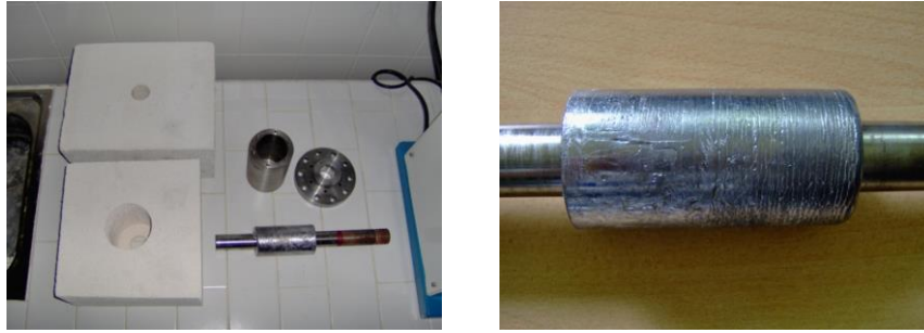
Şekil 2.51 : Kurşunun yerleştirilmesi sonrasında gazbeton blokları ve sönümleyiciye ait parçalar.
