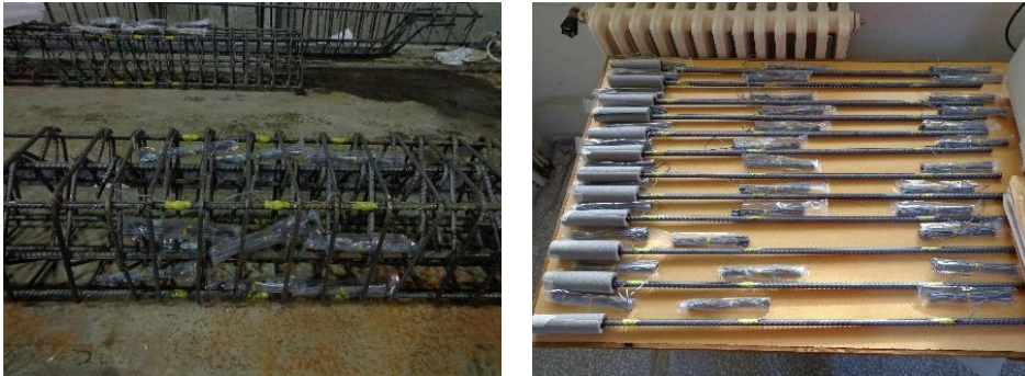
Şekil 3.34 : Boyuna donatılara ve rodla şekil değiştirme ölçerlerin yerleştirilmesi.
