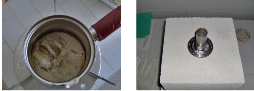
Şekil 2.50 : Kurşunun eritilmesi ve sönümleyici içerisine yerleştirilmesi.
