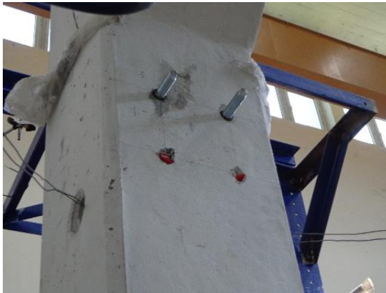
Şekil 3.46 : Ankraj civataları için delik açılması ve civataların yerleştirilmesi.
