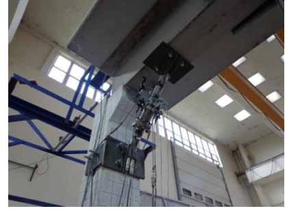
Şekil 3.107 : Kiriş-kolon birleşim bölgesine yerleştirilen yerdeğiştirme ölçerler (Sönümleyicili birleşim).
