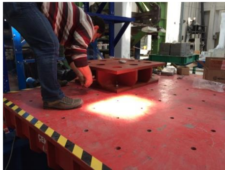
Şekil 3.42 : Soket temel ile sarsma masasının bağlantısı.
