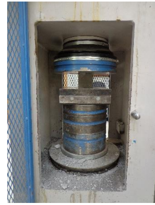
Şekil 3.24 : Harç numunelerinin alınması ve basınç deneyinin yapılması.
