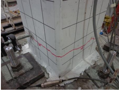
Şekil 3.86 : SF1 testi sonrasında kolonda bulunan eğilme çatlağı.
