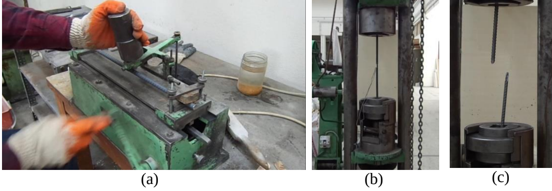
Şekil 3.22 : Donatı çeliği çekme deneyi; (a) Numune üzerinde 1 cm aralık ile işaretleme yapılması, (b) Deney düzeneği, (c) Donatı çeliğinin kopması.
