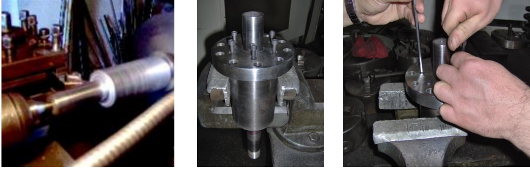
Şekil 2.52 : Kurşunun işlenmesi ve sönümleyici aygıt elemanlarının bir araya getirilmesi.
