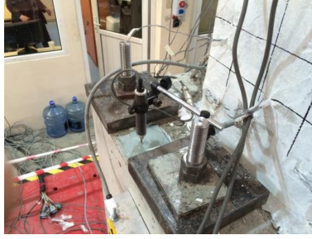
Şekil 3.74 : Kolon alt ucuna yerleştirilen yerdeğiştirme ölçerler (Yalın birleşim).
