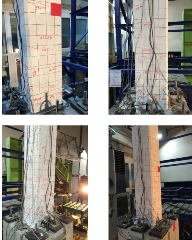
řekil 3.62 : ERZ1.40 testi sonrasında kolonda bulunan eēilme atlakları.
