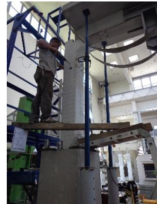
Şekil 3.46 : Ankraj civataları için delik açılması ve civataların yerleştirilmesi.
