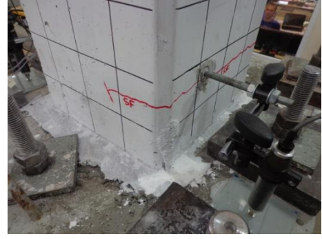
Şekil 3.102 : Kolon alt ucuna yerleştirilen yerdeğiştirme ölçerler (Sönümleyicili birleşim).
