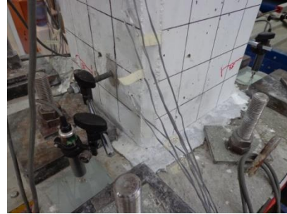
Şekil 3.86 : SF1 testi sonrasında kolonda bulunan eğilme çatlağı.
