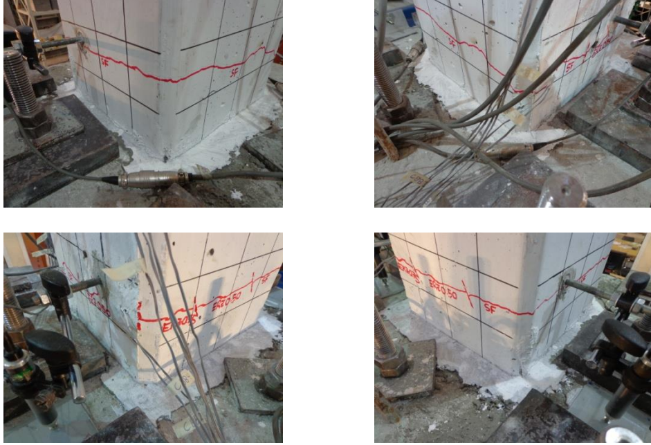
Şekil 3.92 : ERZ1.40 testi sonrasında kolon-temel birleşimi.
