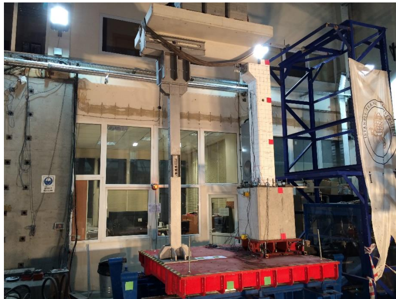
Şekil 3.65 : Yalın birleşim numunesi (Dinamik deney sonrası).
