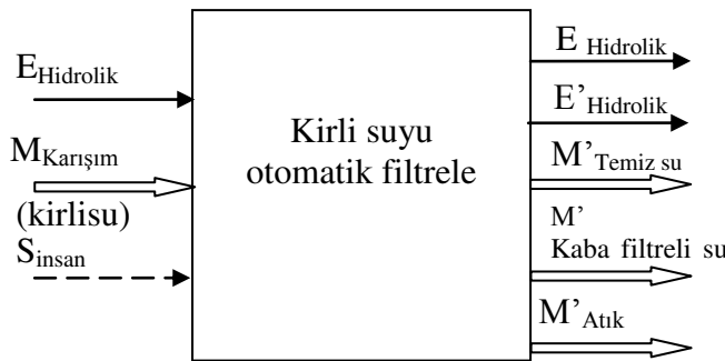
Şekil 8.13. Mekanik filtreye ait tüm fonksiyon yapısı
