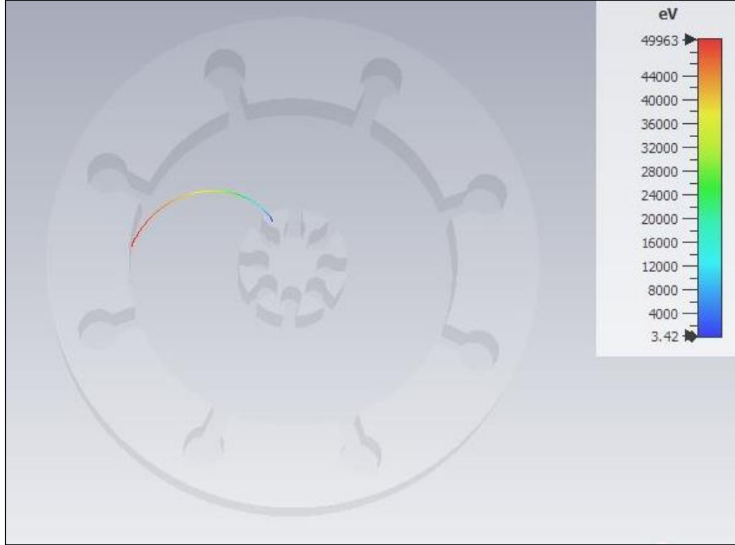
Şekil 4.99. 50 kV gerilim ve 0,07 T manyetik alanın etkisi altında bir elektronun bir turdaki hareketi
