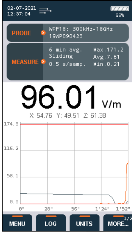
Şekil 5.3. Yatay yönde antenden 10 cm uzaklıkta maksimum elektrik alan değeri
