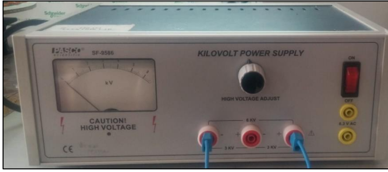
Resim 5.16. Yüksek gerilim güç kaynağı
