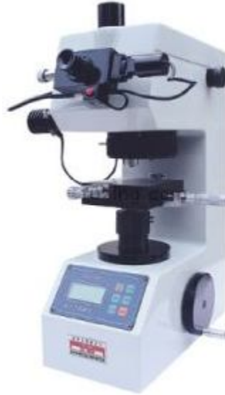
Şekil 3.23. Digital display microhardness test cihazı (HVS-1000)
