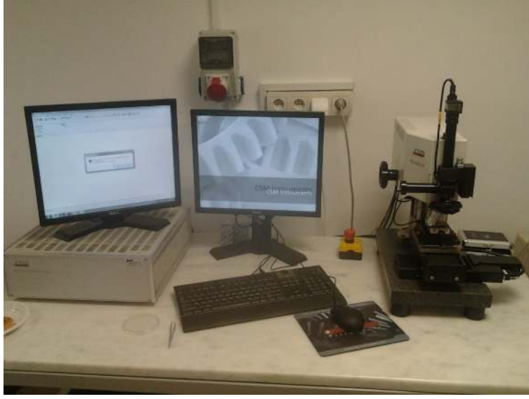
Şekil 3.28. CSM makro scratch test cihazı (CSM instruments- revetest)
