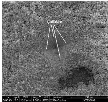
Şekil 4.91. İndentasyon işlemi sonrasında kaplama yüzeyinde oluşan iz (YBS'de 24 saat bekletme süresinde oluşturulan kaplama)
