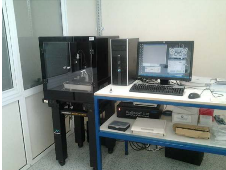
Şekil 3.25. Nano indentasyon cihazı (IBIS DME-DS 95 Series)
