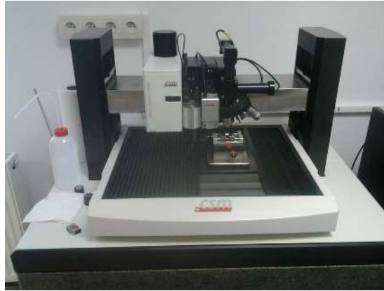
Şekil 3.27. CSM micro scratch test cihazı (CSM MST 02-04830)
