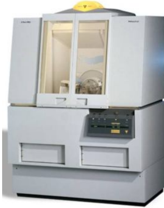
Şekil 3.30. X Işınları kırınım cihazı (XRD) (Philips X'Pert Pro)
