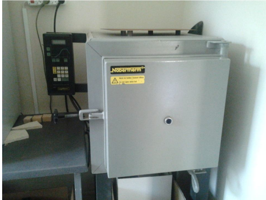
Şekil 3.8. Isıl işlem fırını (Nabertherm N50)
