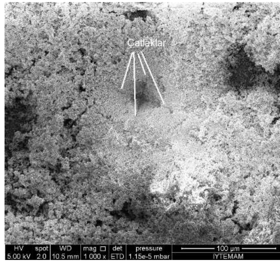
Şekil 4.93. İndentasyon işlemi sonrasında kaplama yüzeyinde oluşan iz (YBS'de 72 saat bekletme süresinde oluşturulan kaplama)
