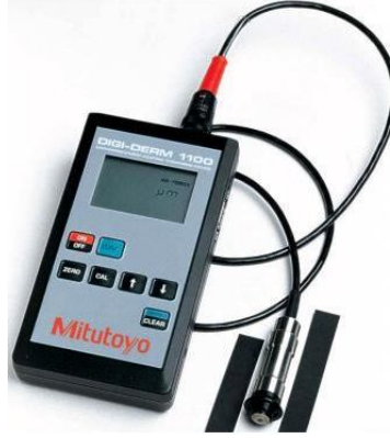
Şekil 3.17. Dijital Kaplama Kalınlığı Ölçüm Cihazı (Mitutoyo DIGI-DERM 1100)
