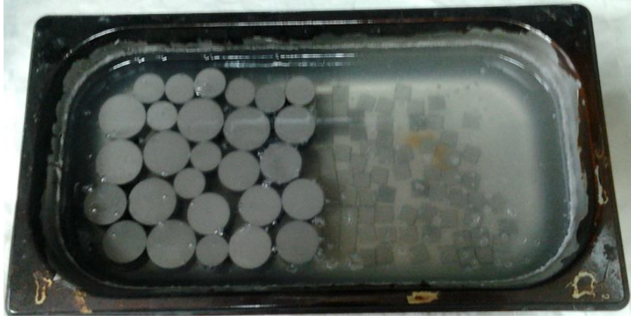
Şekil 3.11. Altlıkların kostik banyosundaki görüntüsü
