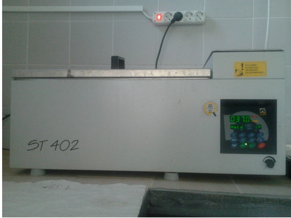
Şekil 3.3. Çalkalamalı ve ısıtmalı su banyosu (Nüve St-402)
