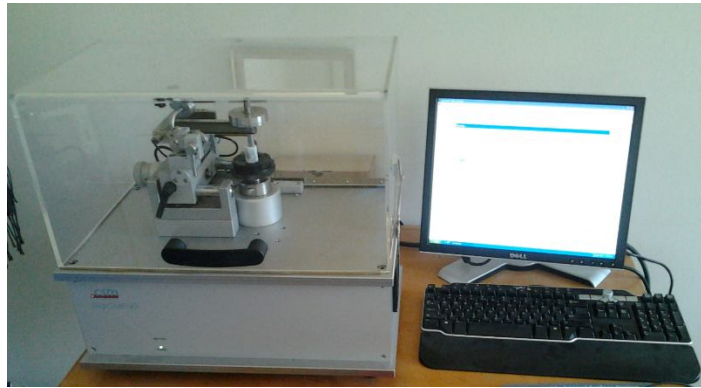
Şekil 3.18. CSM Instruments Tribometer (Aşınma Cihazı)
