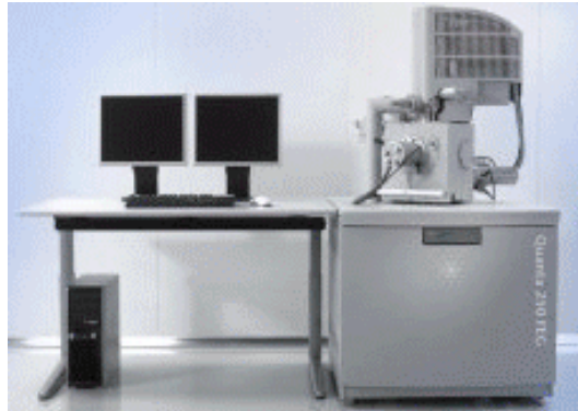
Şekil 3.29. Taramalı elektron mikroskobu (SEM) (QUANTA 250 FEG)
