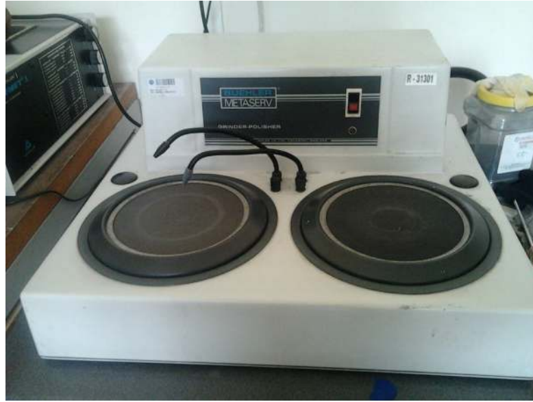
Şekil 3.2. Zımparalama ve parlatma cihazı (Buehler-Metaserv R-31301)
