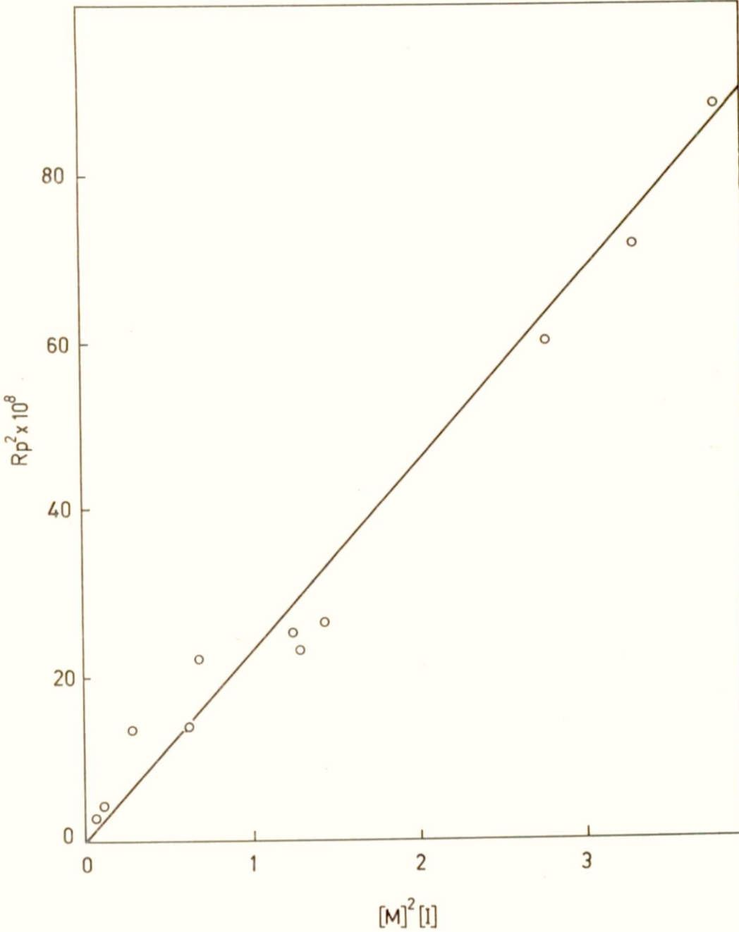
Şekil 24. Polimerik peroksikarbamatla başlatılmış metil metakrilat polimerizasyonu için [M]^2 [I] ye
