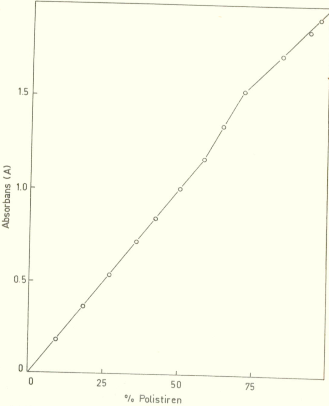
Şekil 13. UV bölgesinde, 169 nm'de, polistiren çözeltileri için, % konsantrasyona karşı absorbans değerleri arasında çizilen "standard" grafik.
