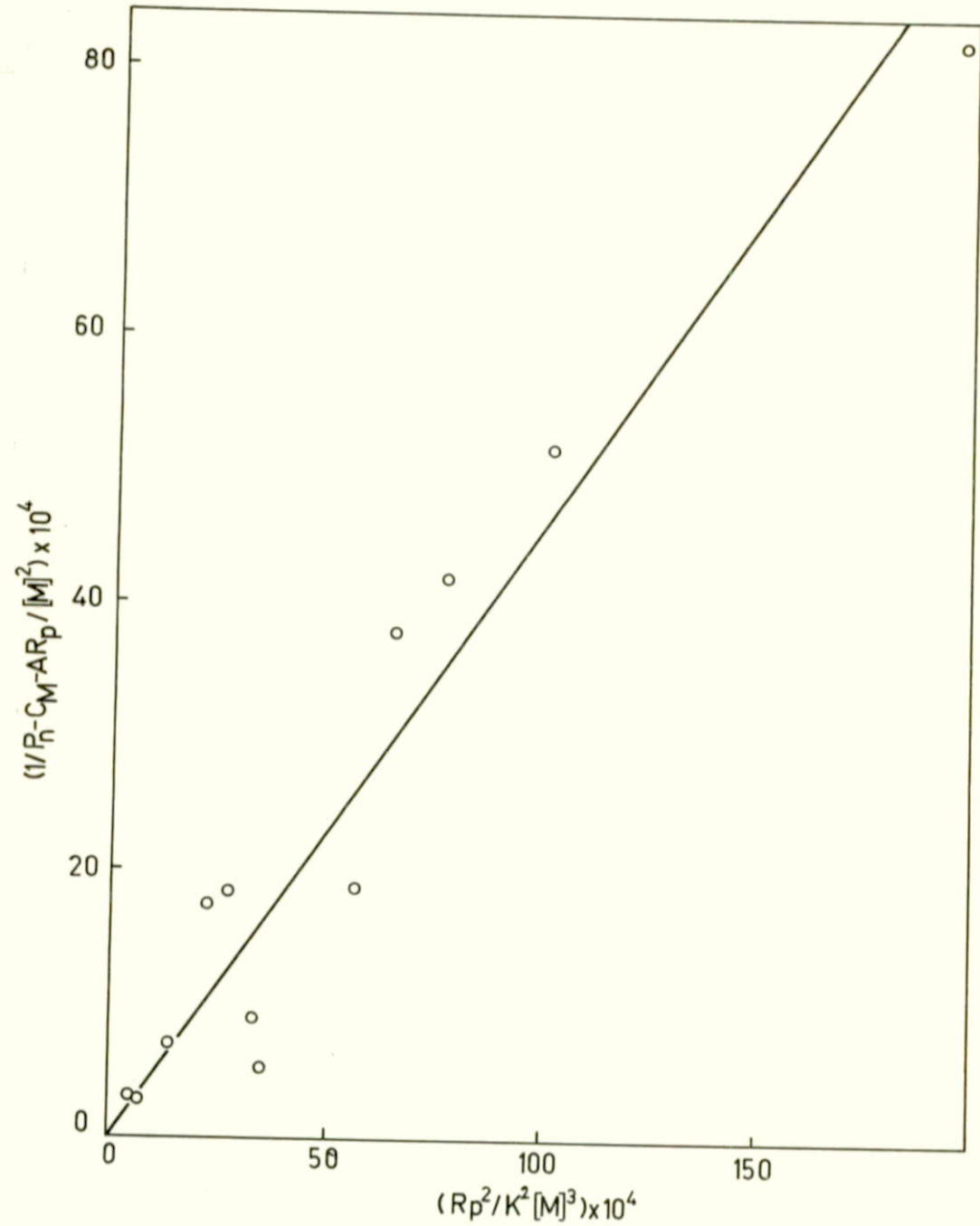
Şekil 25. Polimerik peroksikarbamatla başlatılmış metil metakrilat polimerizasyonu için R_p^2 / K^2 [M]^3 'e karşı (1/P_n - C_M - AR_p / [M]^2) \times 10^4 'e
