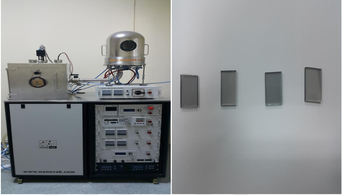
Şekil 5.7. Termal buharlaştırma sistemi ve üretilen Pt filmler
