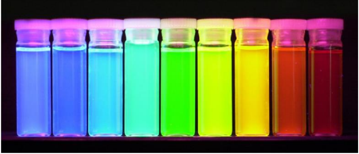
Şekil 2.7. CdSe kuantum nokta çözeltisinin UV ışığı altındaki renkleri. Kuantum noktaların boyutu soldan sağa doğru 2 nm’ den 6 nm’ ye kadar artmaktadır [58].
