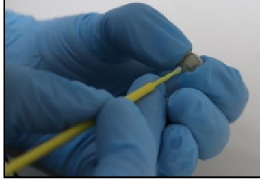
Şekil 3.17: 5x5 mm 2 'lik çalışma alanlarına peptit ajanlarının uygulanması
