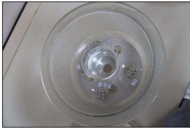
Şekil 3.19: Desikatöre konulan mine örnekleri
