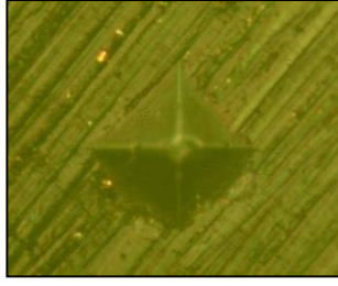
Şekil 4.19a: P2 süt dişi grubuna ait mine örneğinin başlangıç Vickers mikrosertlik testi izdüşüm görüntüsü
