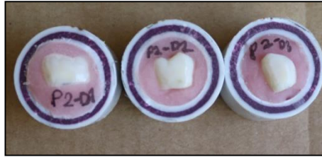
Şekil 3.21: Akrilik rezinlere sabitlenen mine örnekleri
