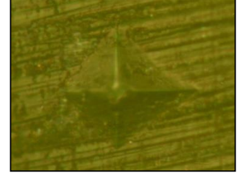
Şekil 4.22c: P2+P3 daimi diş grubuna ait mine örneğinin remineralizasyon sonrası Vickers mikrosertlik testi izdüşüm görüntüsü
