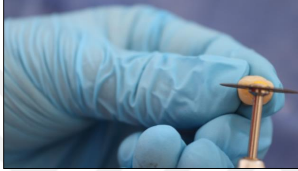
Şekil 3.1: Mine örneklerinin mesiodistal olarak 2 parçaya ayrılması
