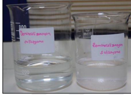
Şekil 3.15: pH siklüsü için hazırlanan demineralizasyon-remineralizasyon solüsyonları
