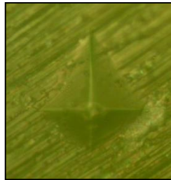
Şekil 4.20b: P3 daimi diş grubuna ait mine örneğinin demineralizasyon sonrası Vickers mikrosertlik testi izdüşüm görüntüsü
