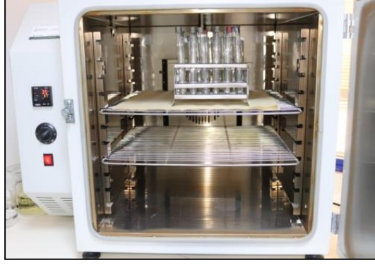
Şekil 3.14: Etüvde bekletilen mine örnekleri
