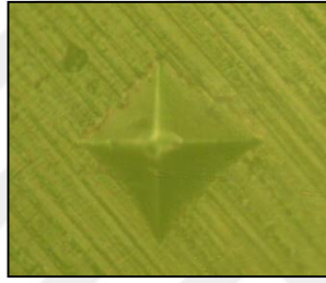
Şekil 4.25b: Florür süt diş grubuna ait mine örneğinin demineralizasyon sonrası Vickers mikrosertlik testi izdüşüm görüntüsü
