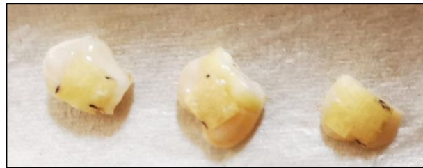
Şekil 3.3: 5 \times 5 \text{ mm}^2 'lik çalışma alanlarına kağıtların yapıştırılması
