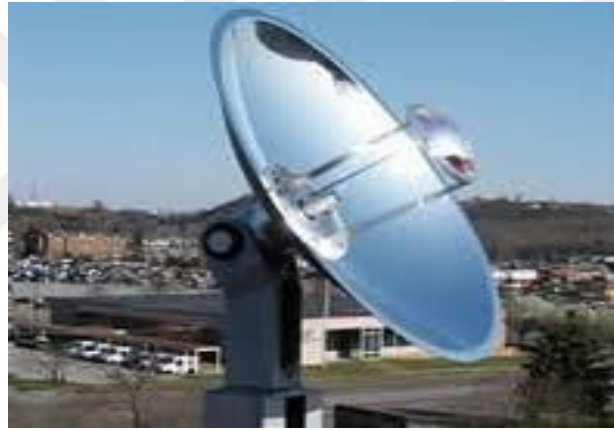
Şekil 1.5. Çanak tipli güneş kolektörü (Parabolik çanak)
