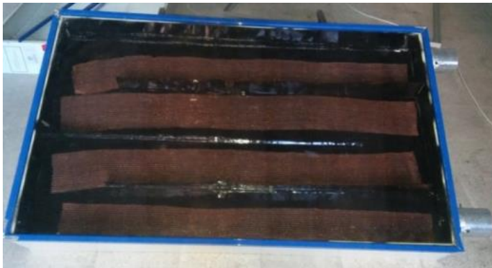
Şekil 3.2. Bakır elek telli emici plakaya sahip havalı güneş kolektörü
