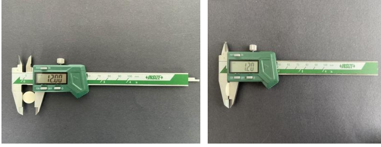
Şekil 3-4: Transludent zirkonya örneklerin boyutlarının kontrol edilmesi
