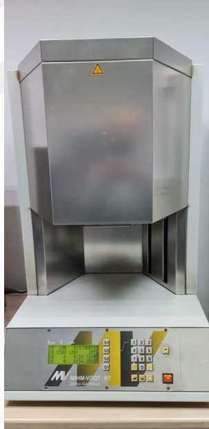
Şekil 3-3: Sinterlemede kullanılan fırın
