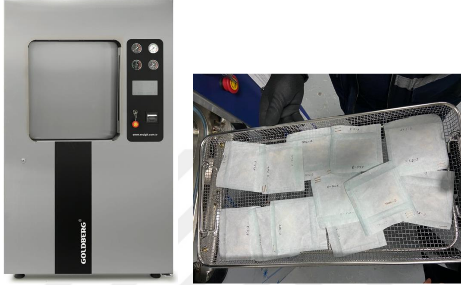
Şekil 3-13: Yaşlandırma işleminde kullanılan otoklav ve örneklerin otoklava yerleştirilmesi
