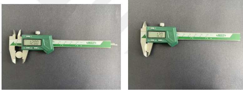
Şekil 3-9: LS 2 disklerin boyutlarının kontrolü
