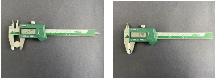
Şekil 3-6: ZLS disklerin boyutlarının kontrolü
