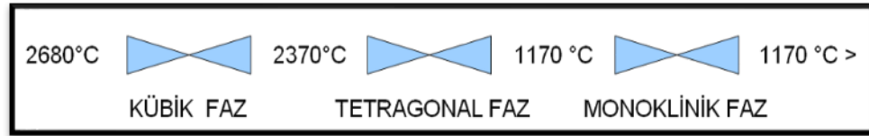
Şekil 2-4: Zirkonya kristal fazlarının dönüşüm sıcaklıkları
