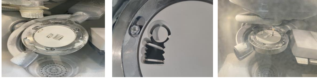
Şekil 3-2: Transludent zirkonya disklerin üretilmesi
