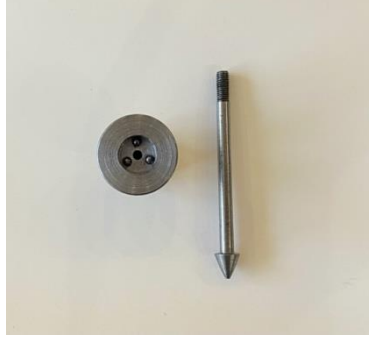
Şekil 3-16: Hazırlanan disklerin üzerine yerleştirildiği düzenek
