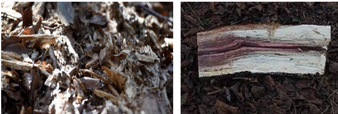
Şekil 1.1 : Beyaz çürükçül fungusların odunda bıraktığı beyaz görüntü. ( https://www.hemel.com.tr ; https://en.wikipedia.org )
