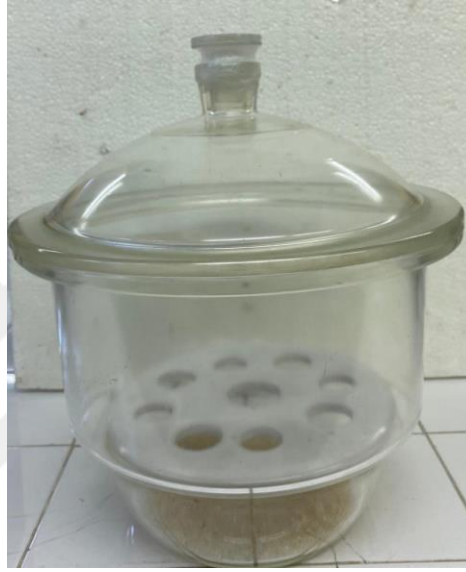
Şekil 11. Su emilimi ve suda çözünürlük ölçümleri için kullanılan desikatör
