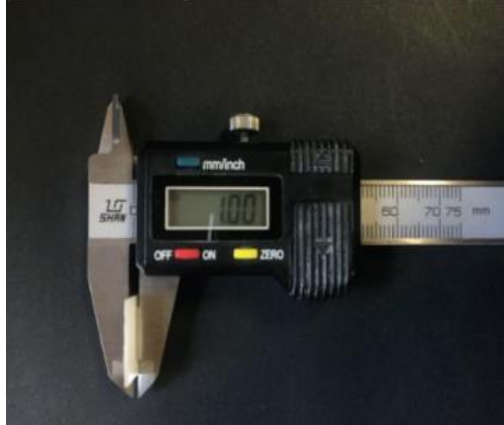
Resim 4. Dijital kumpas ile kalınlık ölçümü
