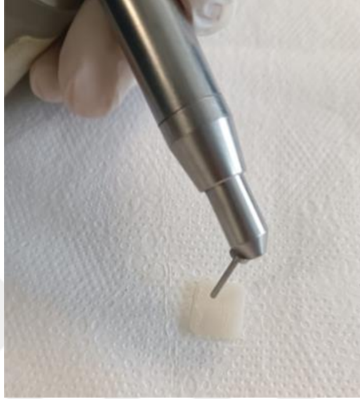
Resim 15. Örnek yüzeylerine kumlama işlemi uygulama
