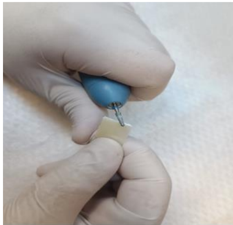
Resim 2. Örnek kenarlarının seramik bitim freziyle düzeltilmesi
