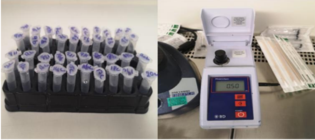
Resim 32. Tüp içinde TBS besiyerinde S. mutans ve S. mutans yoğunluğu ölçümü
