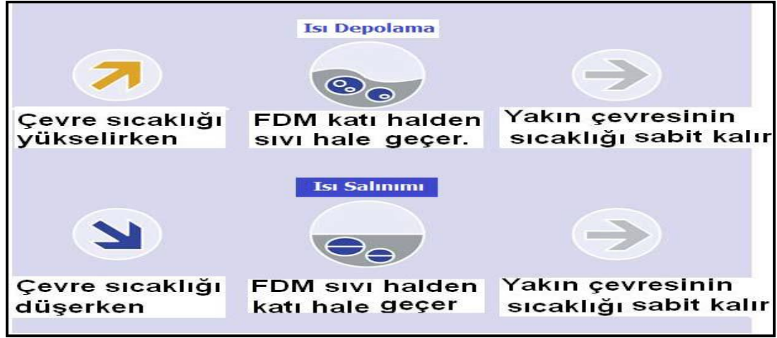
Şekil 2. 1 Katı-sıvı faz değişimi gerçekleştiren malzemelerin ısı depolaması ve ısı salınımı
