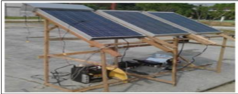
Şekil 2. 24 Referans-PV, FDM1-PV, FDM2-PV kurulu dış mekân deney düzeneği
