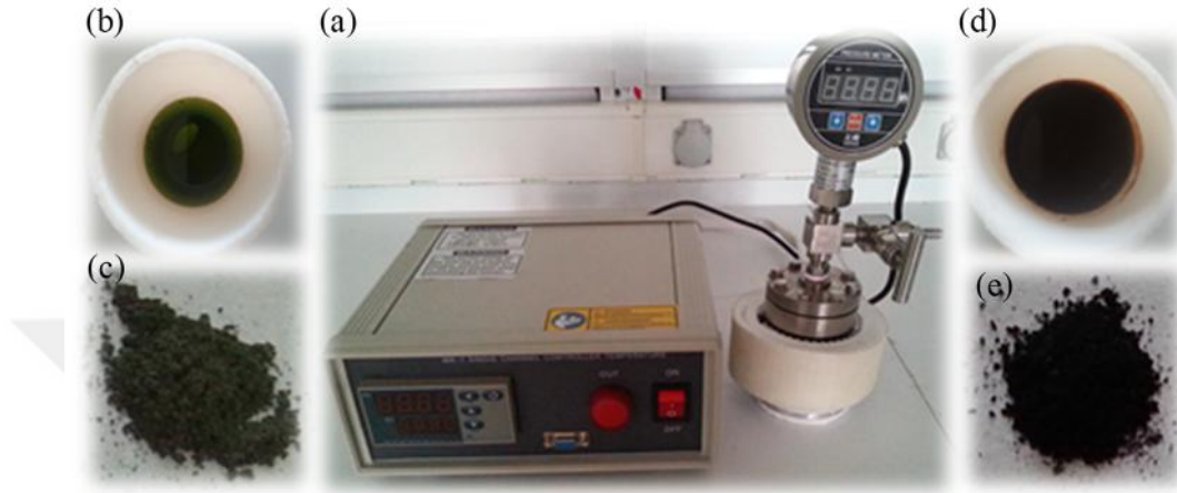
Şekil 3.1. CCO ve CFO nanoparçacıkların hidrotermal yöntem ile eldesi: (a) hidrotermal ünite, (b) CCO çözeltisi, (c) CCO tozu, (d) CFO çözeltisi, (e) CFO tozu
