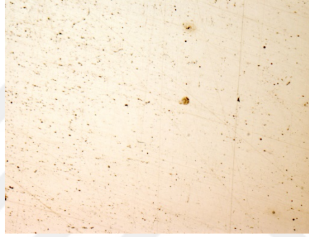
Şekil 5.25 4130-2 döküm uygulamasında orta ekzotermik karakterli besleyici gömlek metalinin 3 nolu bölge görüntüsü.(besleyici gömleğe temas eden yüzey)
