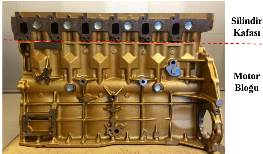
Şekil 2.1 : Ford Ecotorq 9.0 lt. dizel Euro-5 motorunun silindir kafası ve motor bloğu.
