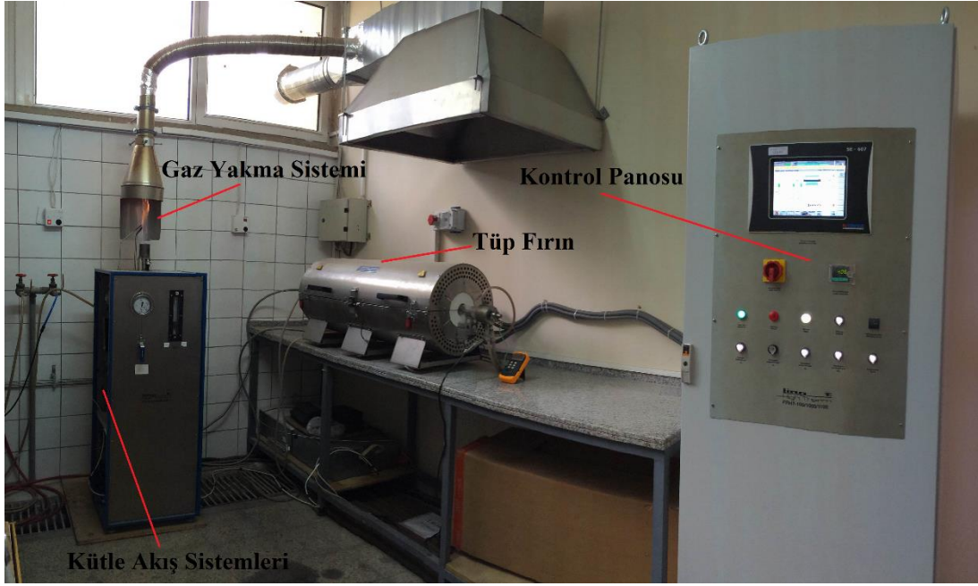
Şekil 5.8 : Gaz nitrüleme fırını “Linn High Therm FRHT-100/1000/1100”.
