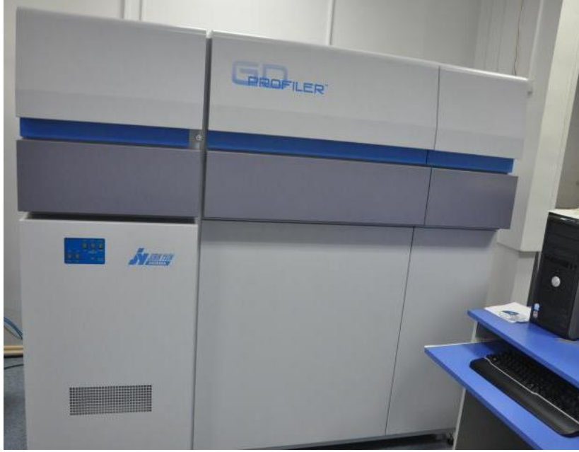
Şekil 5.12 : GDOES cihazı “HORİBA Jobin Yuon GD Profiller”.
