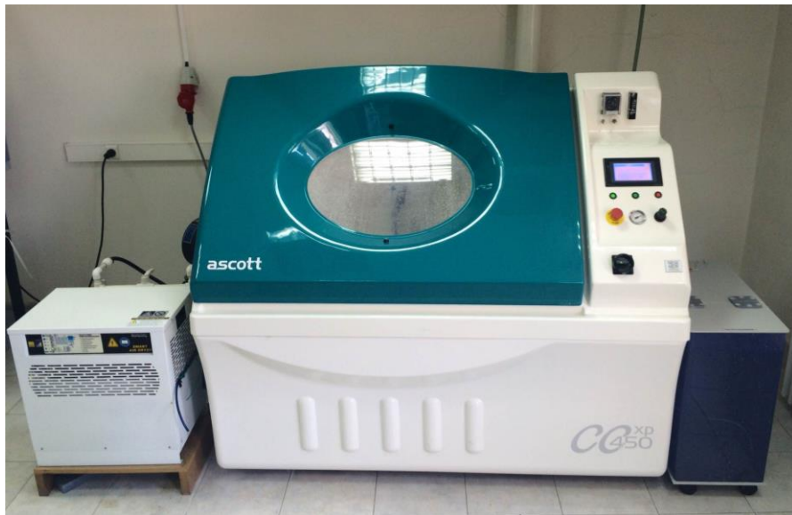
Şekil 5.15 : Tuz püskürtme test cihazı “Ascott CC450 xp ”.
