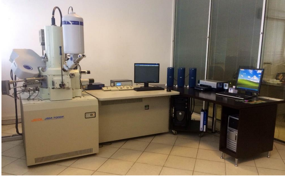
Şekil 5.13 : SEM cihazı “JEOL JSM 7000F”.
