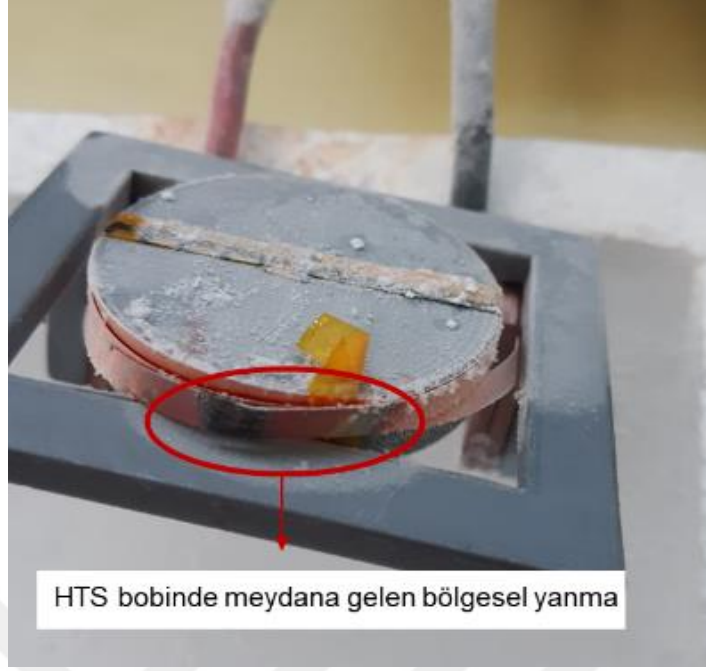
Şekil 71. 120 A uygulandığında HTS bobinde meydana gelen bölgesel yanma
