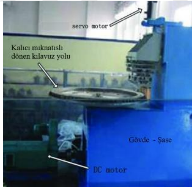
Şekil 10. SCML-03 Maglev dinamik test sisteminin ana bölümünün fotoğrafı (Wang vd. 2008)
