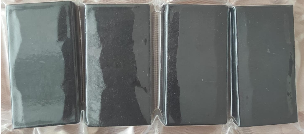
Şekil 53. Tez çalışmasında kullanılan külçe YBCO HTS malzemelere ait fotoğraf
