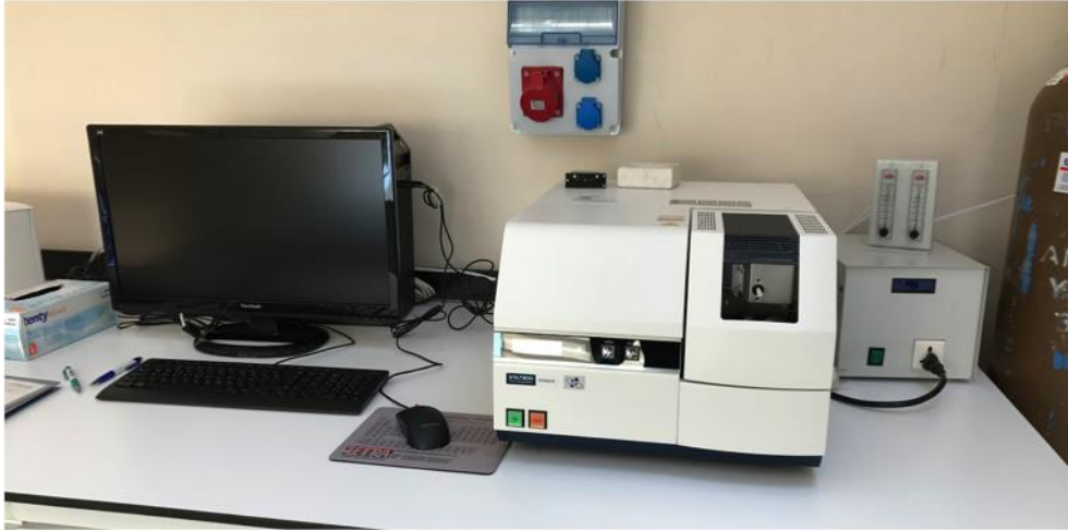
Şekil 3.10. Termal analizlerin yapıldığı TD-DTA cihazı
