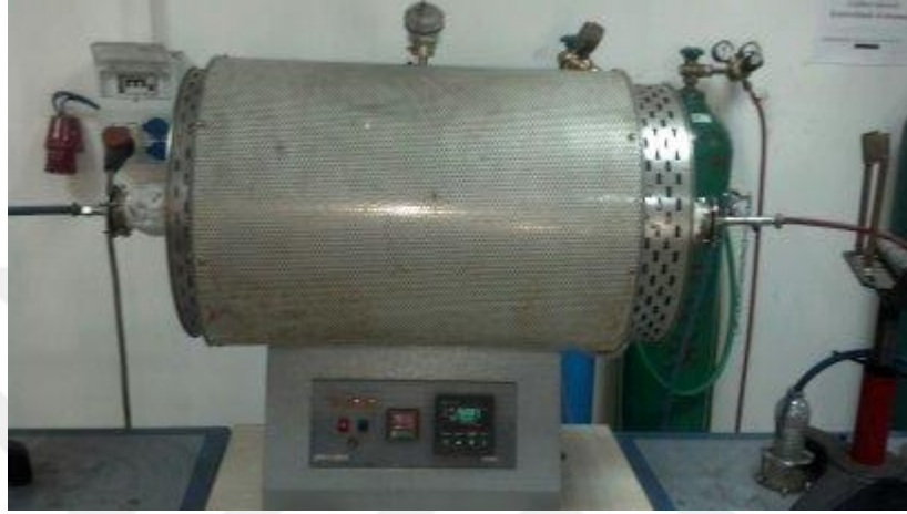
Şekil 3.8. Basıncsız Sinterleme işleminde kullanılan dikey tüp fırın
