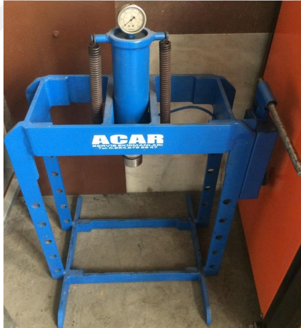
Şekil 3.7. Kullanılan tek eksenli hidrolik pres
