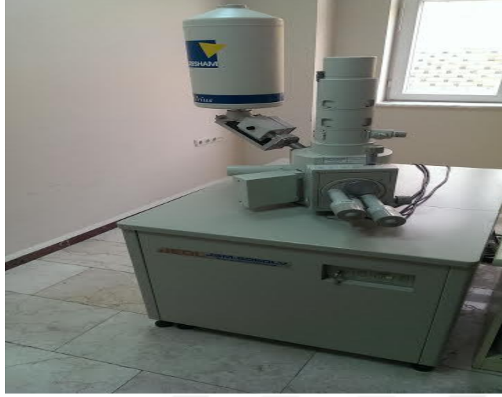
Şekil 3.14. Mikro yapı görüntülerinin çekildiği taramalı elektron mikroskobu
