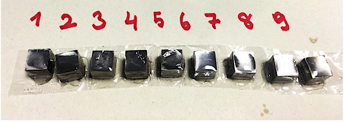
Şekil 4. 13. Epoksi reçine ile yüzeyleri kaplanmış numuneler
