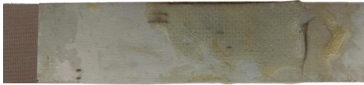
Şekil 4.9. Mod I- çift konsol kiriş testi sonrası alüminyum yüzeylerindeki hasar görüntüleri
