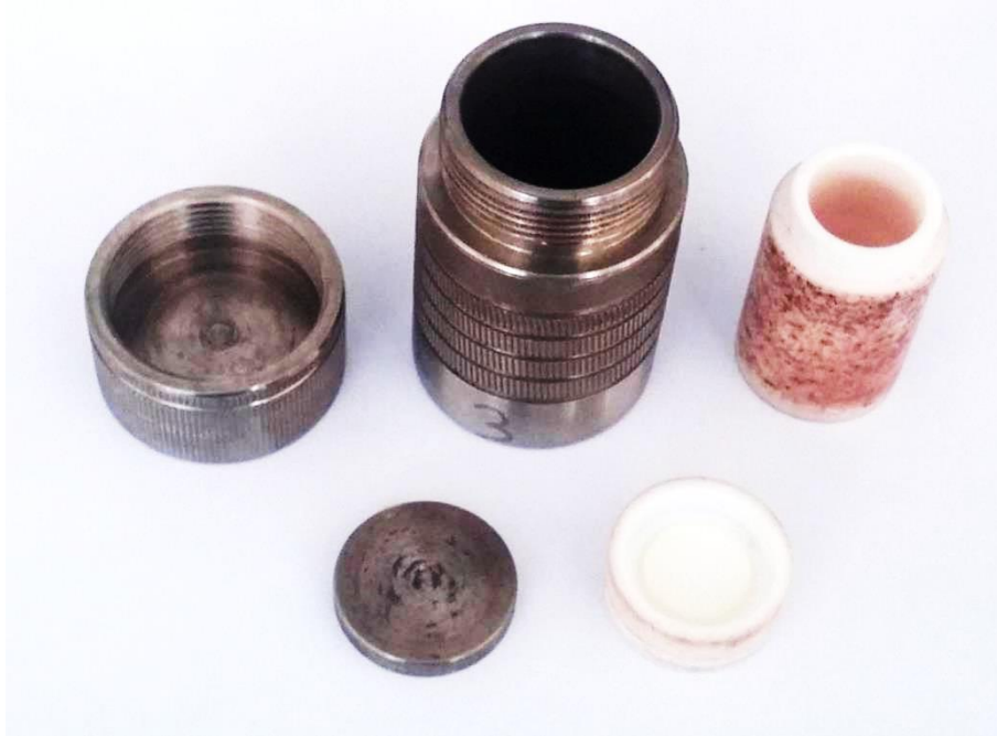
Şekil 10. Tez çalışmasında kullanılan solvotermal reaktör
