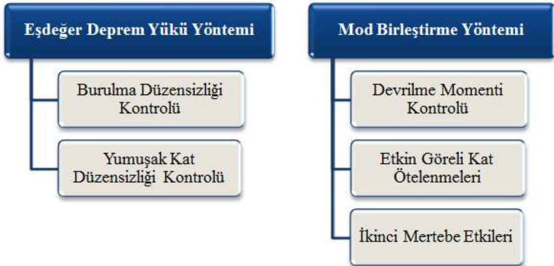
Şekil 3.1. Yapılacak kontroller için kullanılacak hesap yöntemleri
