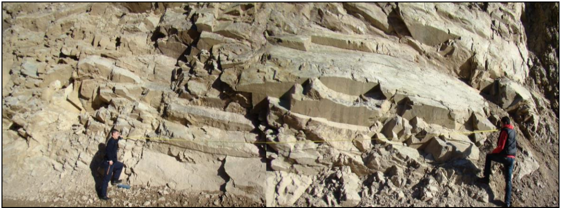
Şekil 10. Hat etüdü yönteminin arazideki şev aynasında uygulanması
