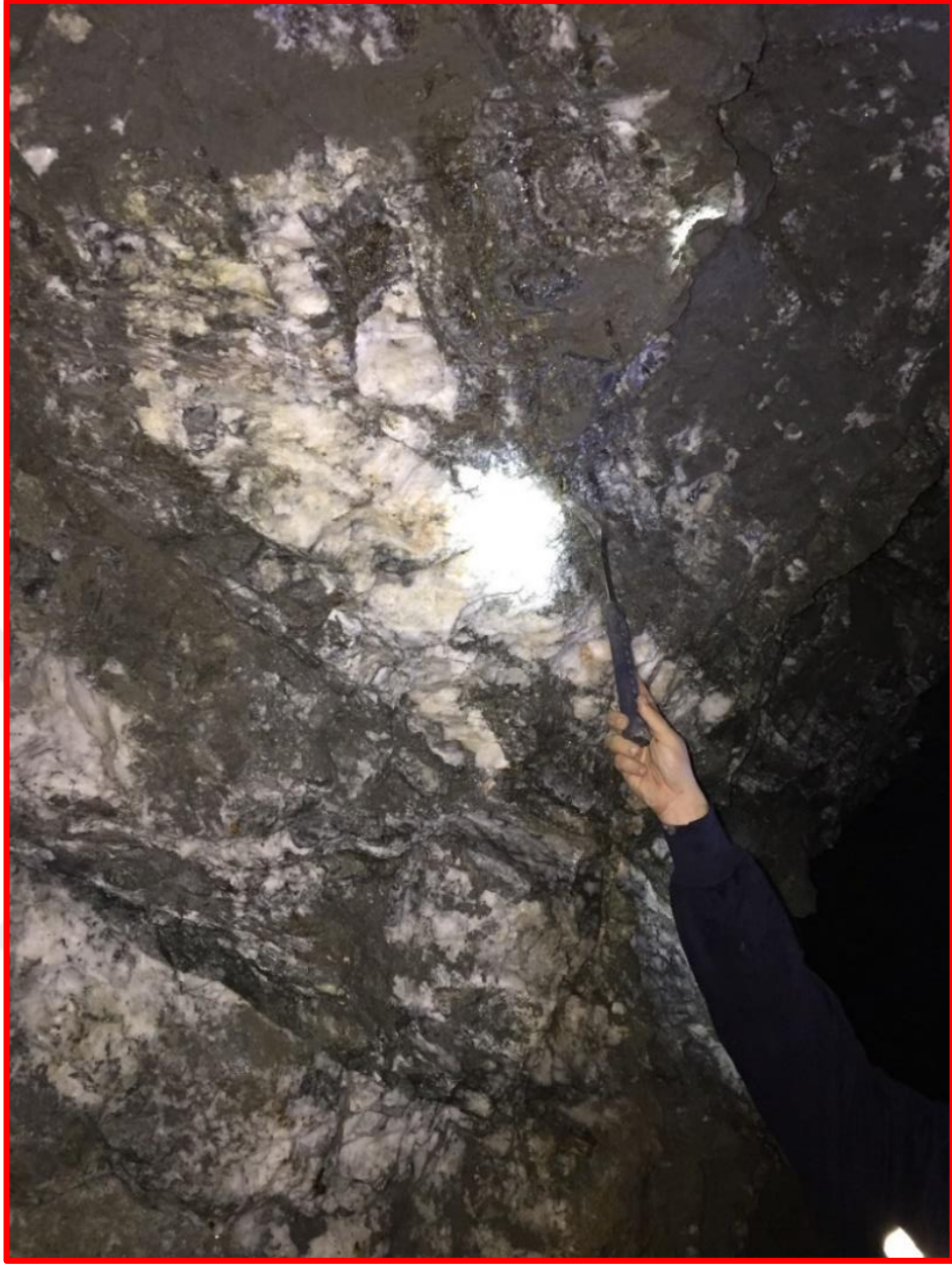
Şekil 4.62 160 kotunda yer alan galerinin IV. damarında gözlenen galen-sfalerit-kalkopirit ve kalsit içerikli cevherleşme (Kişisel arşiv, 2014)
