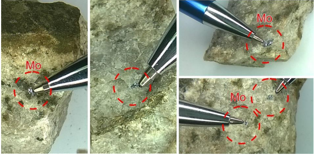
Şekil 4.86 Sofular Mo cevherleşmesinde saçınımlar halinde gözlenen ince taneli molibdenitler. Kısaltmalar: Mo-Molibdenit
