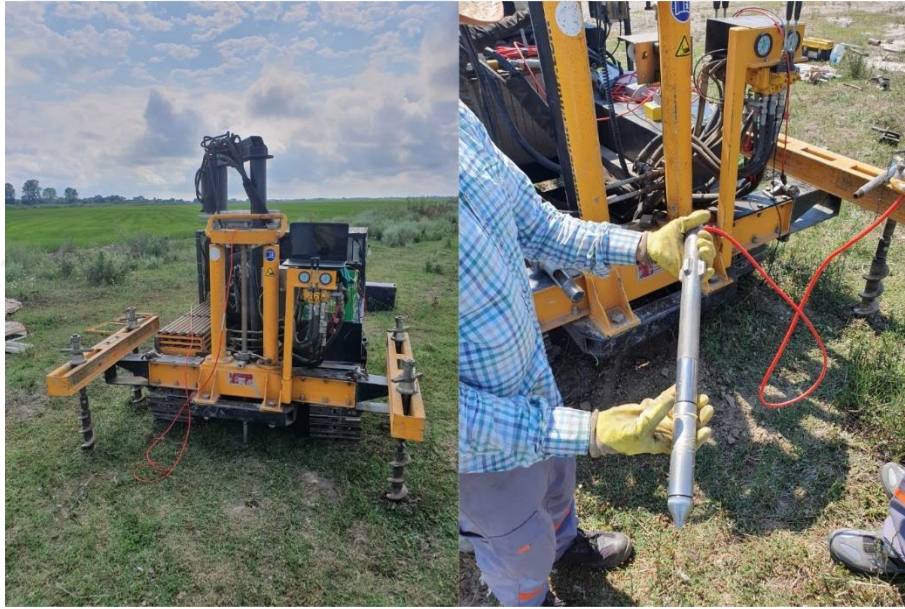
Şekil 14. CPTu deneylerinde kullanılan taşınabilir CPT cihazı ve piezokoni
