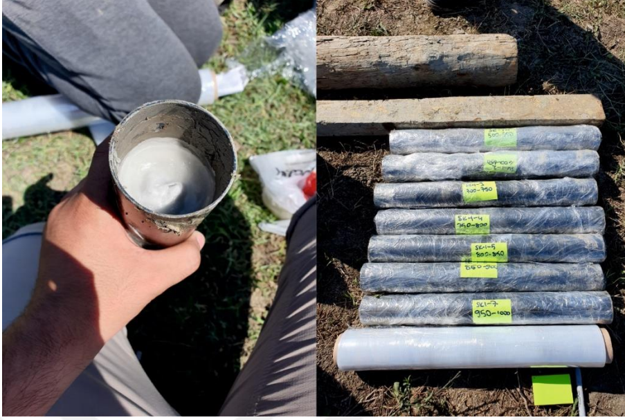
Şekil 13. Örselenmemiş örneklerin parafinlenmesi ve streç filme sarılıp etiketlenmesi
