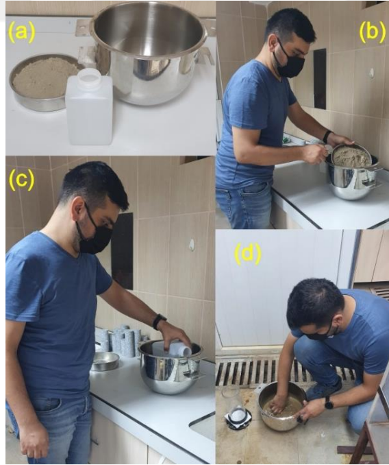
Şekil 29. Yeniden çökeltilmiş örneklerin hazırlanma aşaması. (a) Öğütülmüş örnek, saf su ve karıştırma kabı; (b) Öğütülmüş örneğin karıştırma kabına aktarılması; (c) Saf suyun eklenmesi; (d) Öğütülmüş örnekle saf suyun karıştırılarak bulamacın hazırlanması
