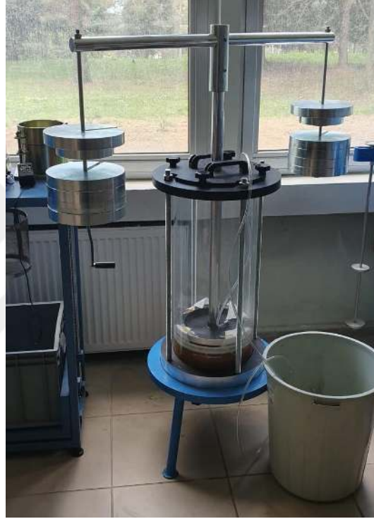
Şekil 26. alışmanın erken aşamasında üretilen büyük konsolidometre cihazı
