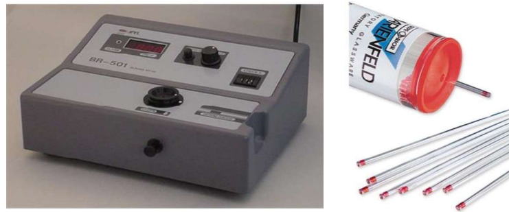
Şekil 3.1. APEL-BR 501 Bilirubinmetre cihazı ve kapiller tüpler.
