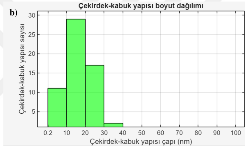
Şekil 4.10 a) Örnek 2'in SEM görüntüsü ve Örnek 2'in çekirdek-kabuk yapısı boyutu (nm) dağılımı (PVP/ODA-MMT/MA/ \text{AgNO}_3 ) 3 mg/mL \text{AgNO}_3 )
