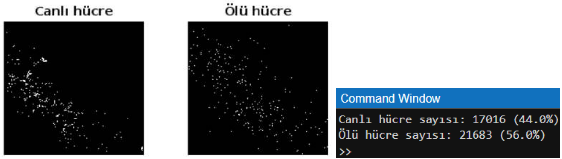
Şekil 4.55 Şekil 4.47 h’da görülen kaplama yüzeylerindeki biyofilmlerin canlı/ ölü hücre analizi (MATLAB’da analiz edilmiştir.)
