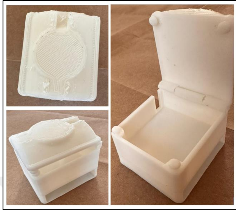
Şekil 51. Göğüs hareketi elektromekanik model 3B baskı
