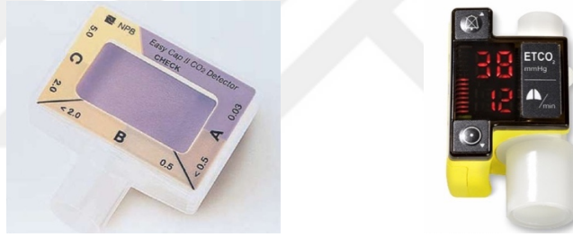
Şekil 3: Kolorimetrik Kapnograf ve Kapnometre [52] [53]
