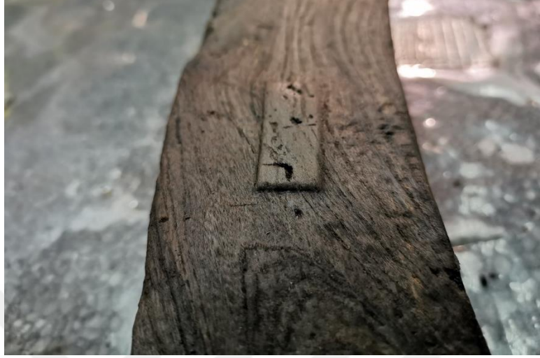
Şekil 4.15: E76 etiket numaralı döşekte yüzey aşınması.
