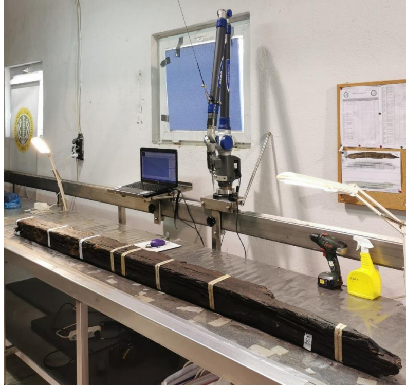
Şekil 4.18: İç Omurga üzerinde kesit alınacak yerlere çekilen şeritler.
