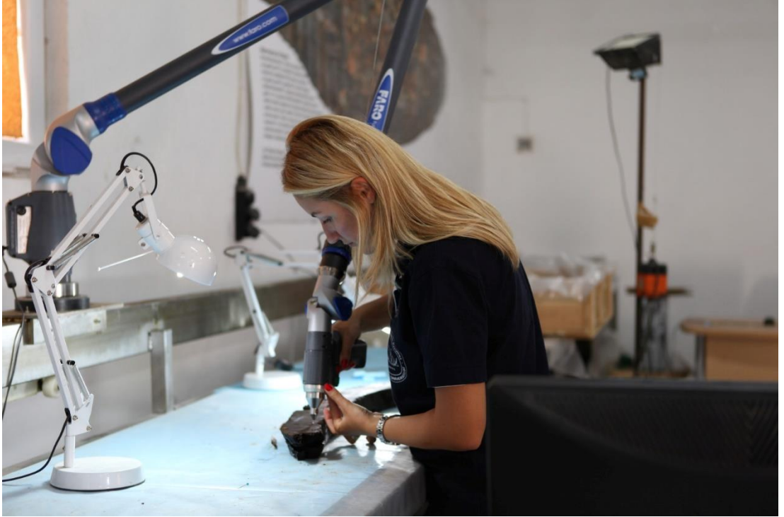
Şekil 2.4: YK16 ahşap elemanlarının FaroArm® cihazı ile çizimi.
