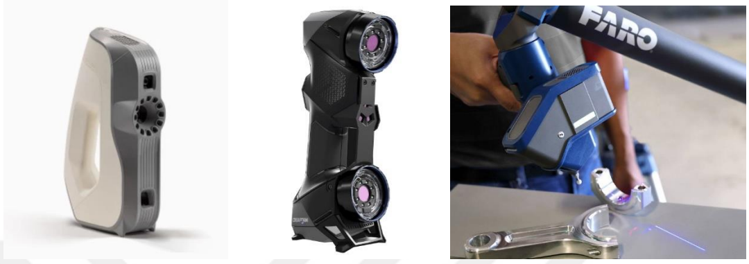
Şekil 3.11: Gemi elemanlarının 3 boyutlu belgelenmesinde kullanılan farklı tarama cihazları.
