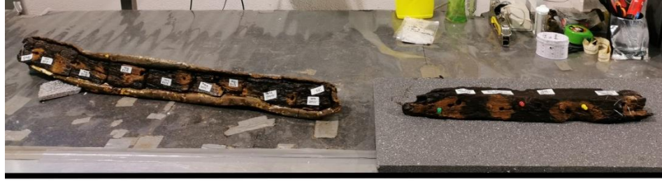
Şekil 4.29: Epoksi kalıp içerisinde izimleri yapılan E11 (üst) ve İSK E19 (alt).
