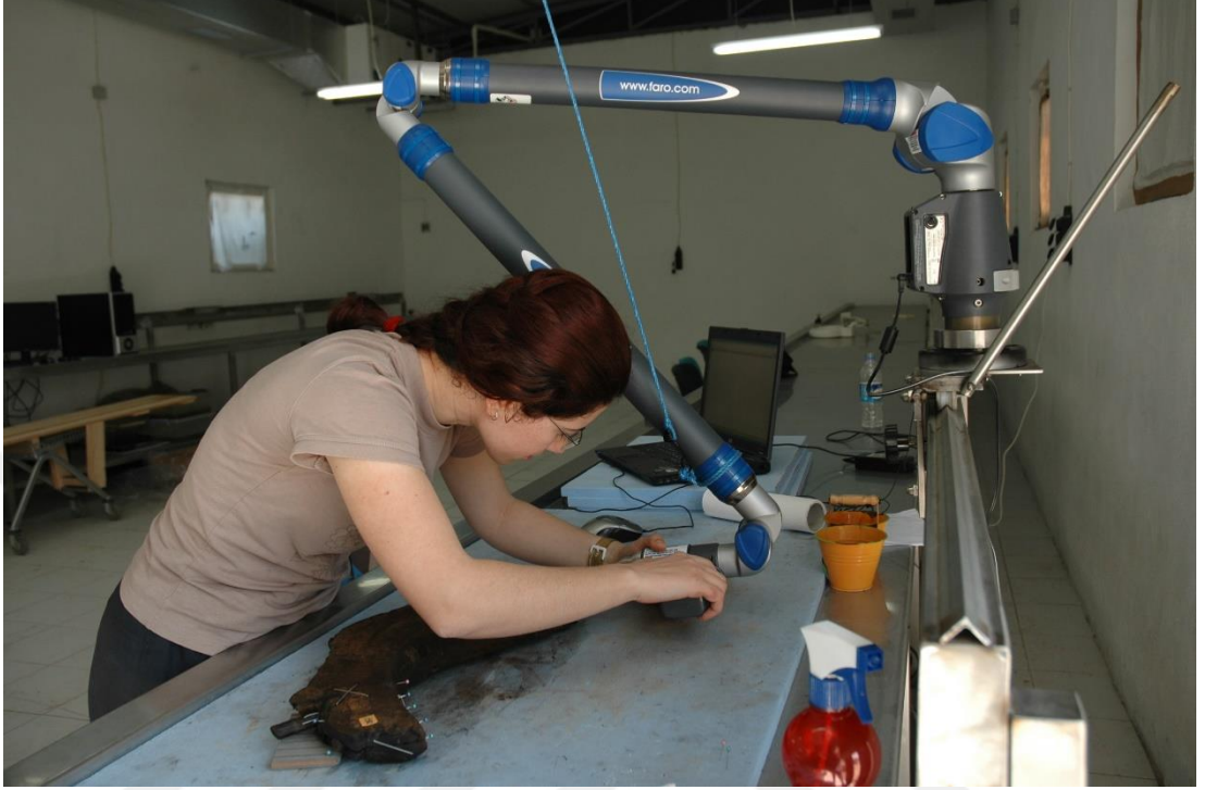
Şekil 3.22: YK3 Batığı ahşaplarında FaroArm® cihazı ile çizim.
