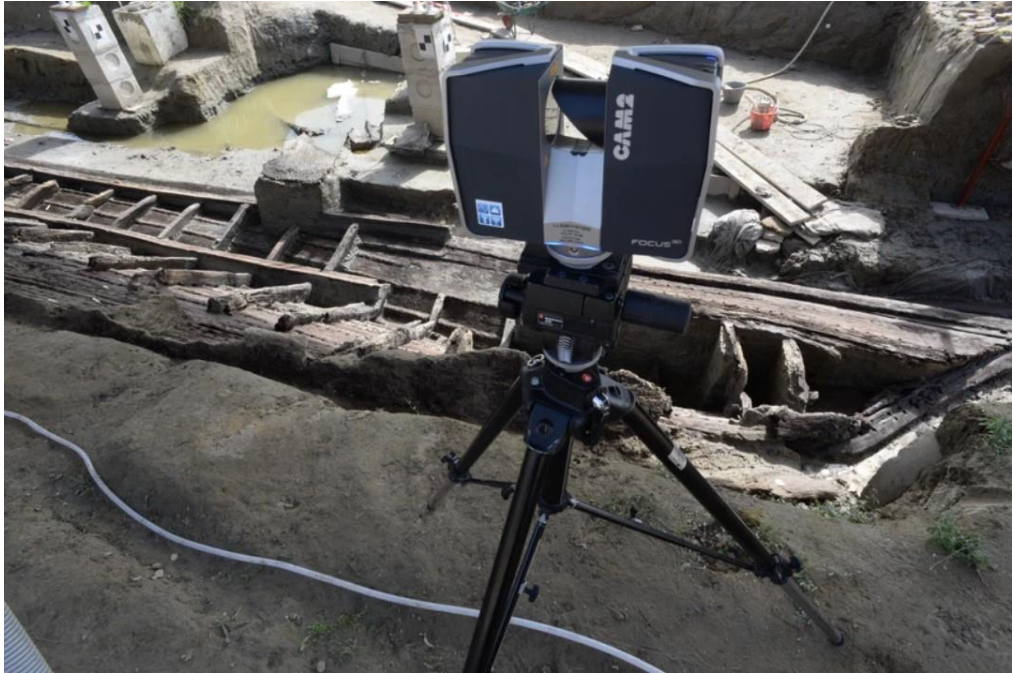
Şekil 3.7: Çalışmalarda Faro Focus 3D lazer tarayıcı kullanımı.
