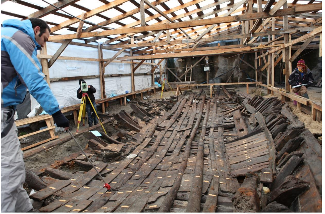
Şekil 3.1: Yenikapı 35 batığı Total Station® ölçümleri.
