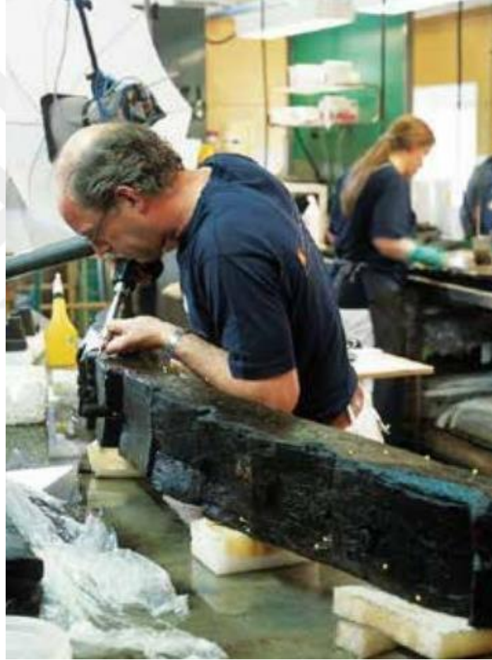
Şekil 3.20: Roskilde gemilerinin FaroArm® cihazı ile belgelenmesi
