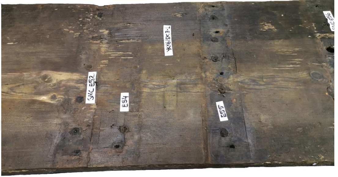
Şekil 4.9: SK3-1 etiket numaralı kaplama üzerindeki eğri baskı izi.
