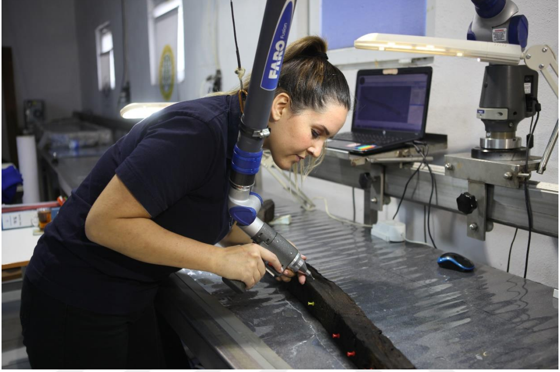
Şekil 3.9: Yenikapı Batıkları Projesinde FaroArm® cihazı kullanımı.
