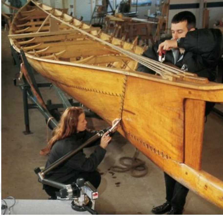
Şekil 3.10: Hjortspring teknesinin replikasının Microscribe ile çizimi.
