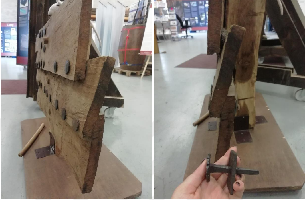
Şekil 4.10: Klinker çivisi ve cıvata pulu.
