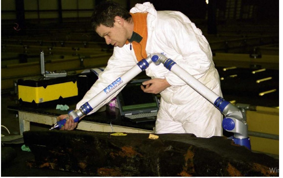
Şekil 3.8: Newport Orta Çağ gemisine ait döşeğin belgelenmesinde FaroArm® kullanımı.
