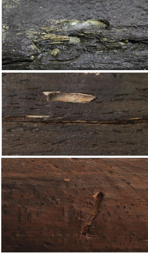
Şekil 3.26: Teredo navalis canlısının omurga üzerinde oluşturduğu hasarlardan bazıları.
