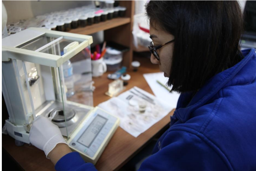
Şekil 2.13: Batıktan alınan örneklerin ıslak ağırlığının ölçümü.
