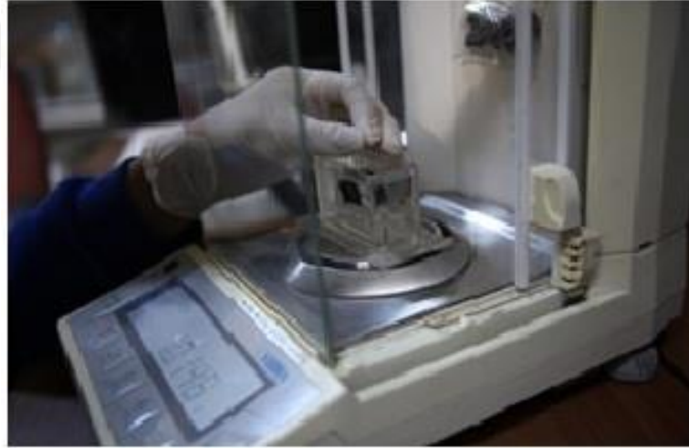
Şekil 2.15: Batıktan alınan örneklerin yüzerliliklerinin ölçümü.
