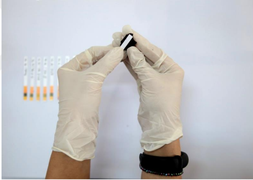
Şekil 2.23: İndikatör şeritler ile batığa ait örneklerin pH ölçümü.
