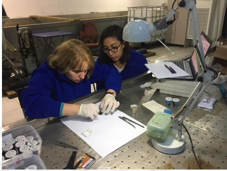
Şekil 2.17: SEM için örnek yüzeyinden kesit alımı.
