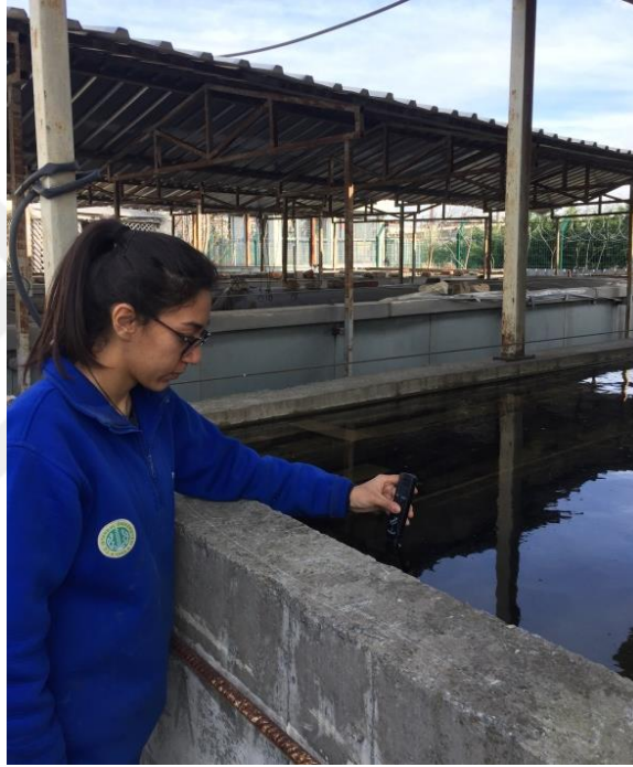
Şekil 2.2: YK 16 batığının ahşap elemanlarının bulunduğu havuzların tuz ölçümleri.
