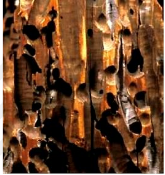
Şekil 3.28: Limnoria 'ların suya doymuş ahşap üzerinde yarattığı tahribat.
