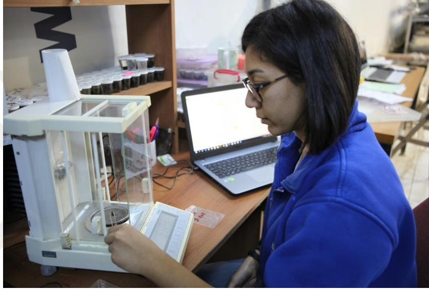
Şekil 2.16: Batıklardan alınan örneklerin fırın kurusu ağırlıklarının ölçümü.
