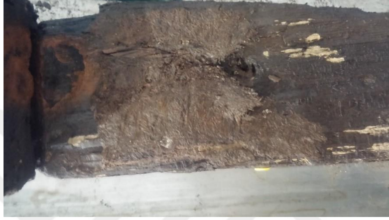
Şekil 21: Omurga gemesindeki serme kalafat kalıntısı
