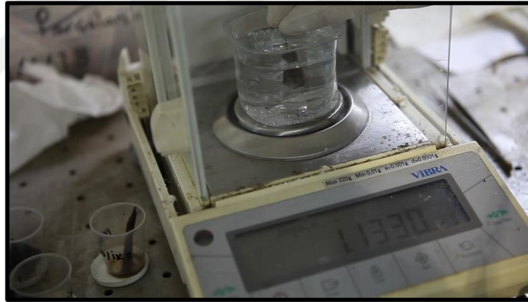
Şekil 2.6: Yüzerlik hesaplamaları için su dolu kap içerisinde gerçekleştirilen tartma işlemi.
