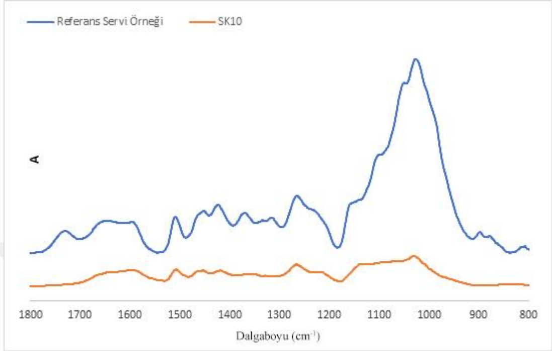
Şekil 3.9: YK 29 SK10 ahşabından alınmış örneğin (turuncu) ve referans servi (mavi) örneğinin FTIR spektrumları.
