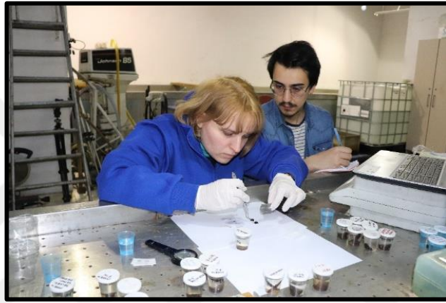
Şekil 2.20: SEM görüntülemeleri için örneklerden kesit alınması.
