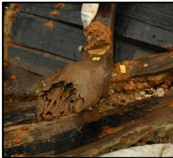
Şekil 1.8: YK 29 E1 ahşabındaki Teredo navalis hasarları.
