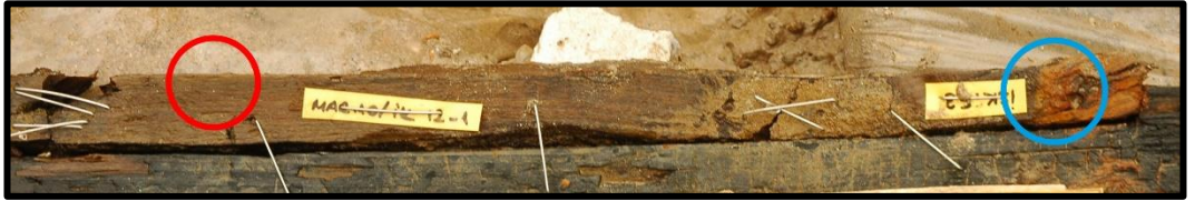
Şekil 2.13: İK12-1 örneğinin alındığı bölge. Mavi: korozyonlu bölge; kırmızı: korozyonsuz bölge.
