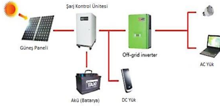
Şekil 2.2. Şebekeden bağımsız off-grid sistem
