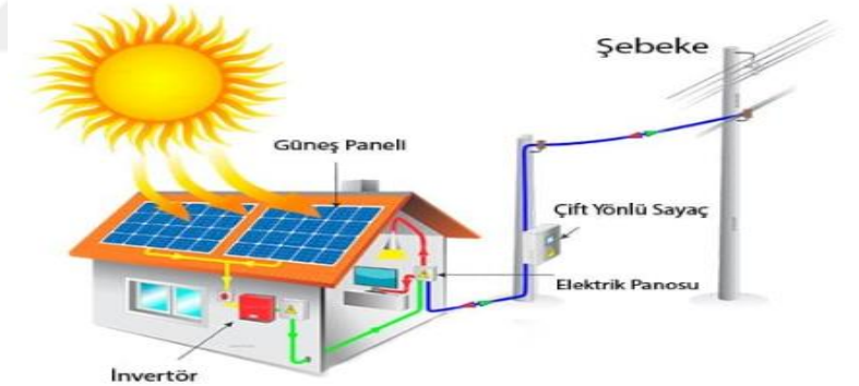
Şekil 2.1. Şebekeye bağlı on-grid sistem
