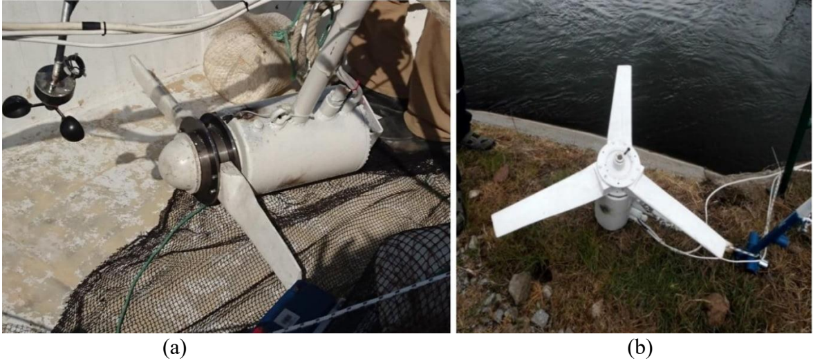
Şekil 3.40: 38 cm uzunluğunda iki kanatlı bir türbine ait rotor bağlantısı (a), 48 cm kanat uzunluğuna sahip üç kanatlı bir türbin prototipi (b)
