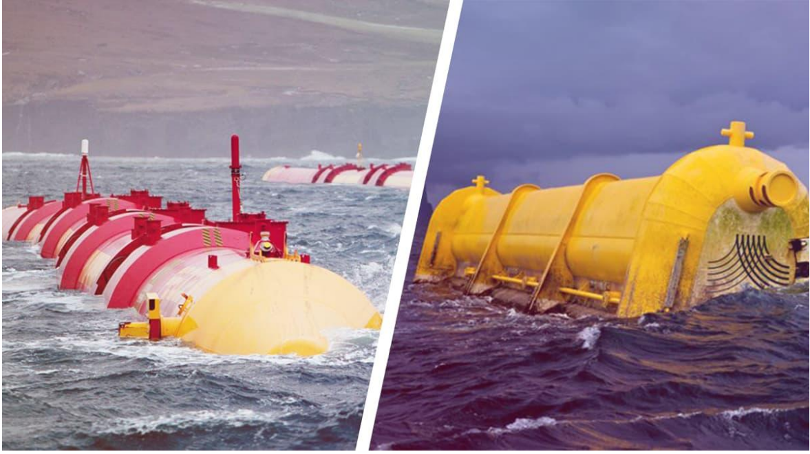
Şekil 3.38: Dalga enerjisi dönüştürücüleri (URL-11, 2024)
