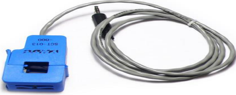
Şekil 3.2 SCT-000-013 akım trafosu sensörü.
