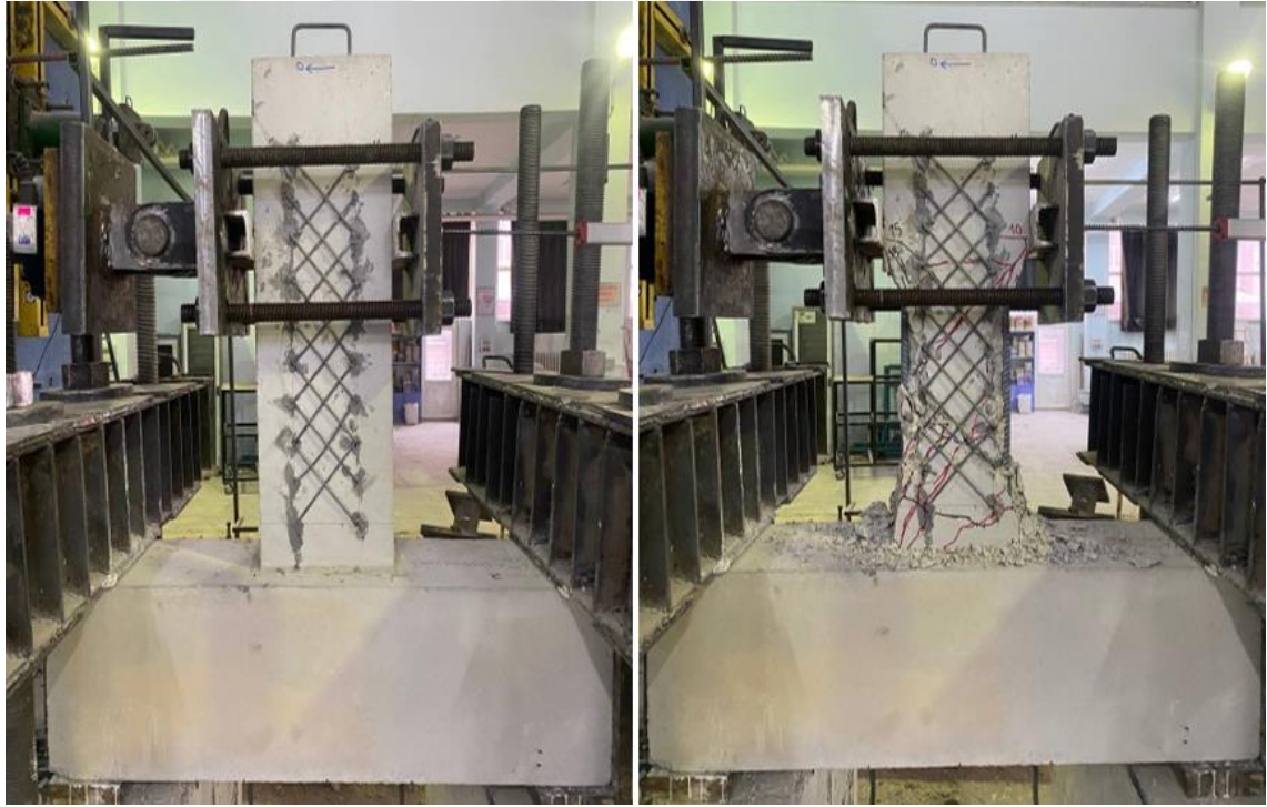
Şekil 4.69. BC15/X3.3-T4-15-45/125-250-0.6-2Ø16/2.5 numunesi deney öncesi ve sonrası görünümü
