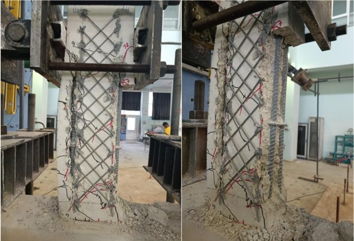
Şekil 4.46. BC5/X3.3-T4-15-45/125-250-0.6-2Ø16/3.3 numunesi deney sonu görünümü
