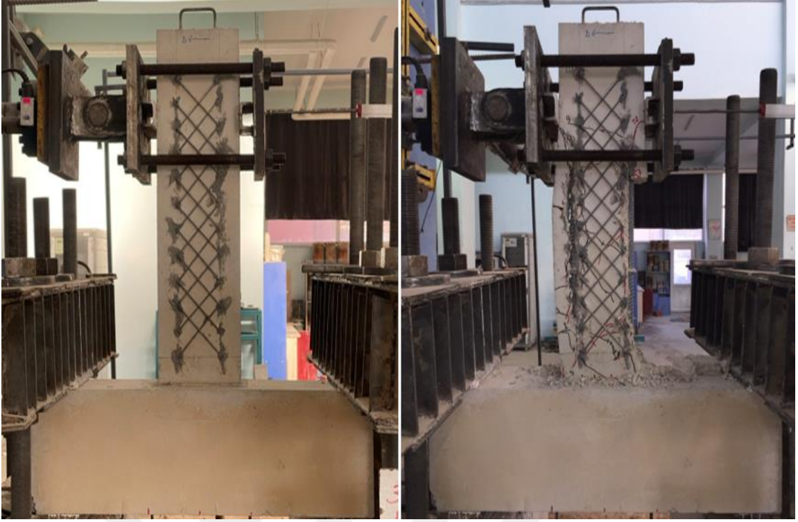
Şekil 4.45. BC5/X3.3-T4-15-45/125-250-0.6-2Ø16/3.3 numunesi deney öncesi ve sonrası görünümü
