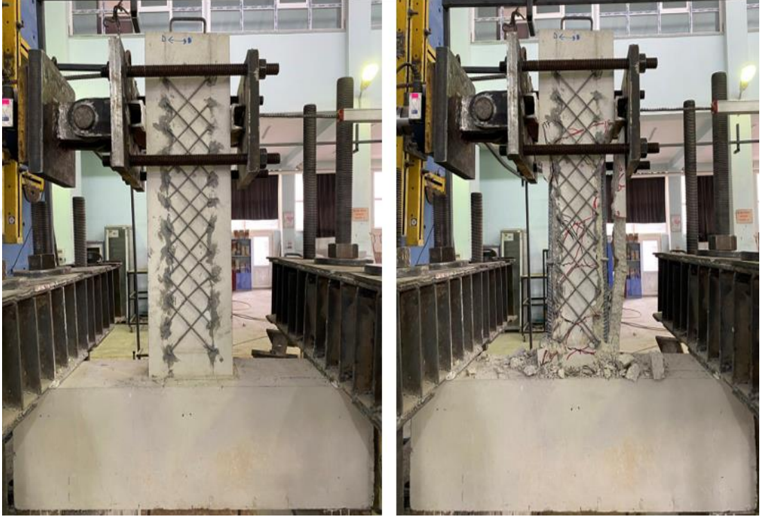
Şekil 4.29. BC15/X3.3-T4-15-45/125-250-0.6-2Ø14/3.3 numunesi deney öncesi ve sonrası görünümü
