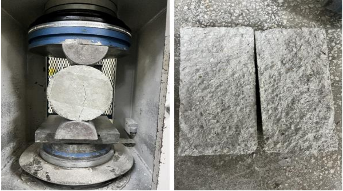
Şekil 3.38. Yarmada çekme deneyi
