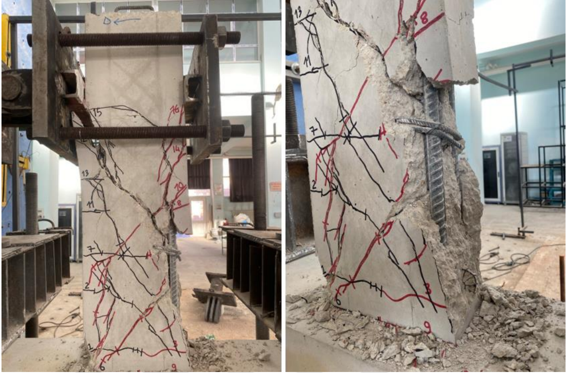
Şekil 4.34. BC15/N0.0-N0-0-0/125-250-0.6-2Ø18/3.3 numunesi deney sonu görünümü
