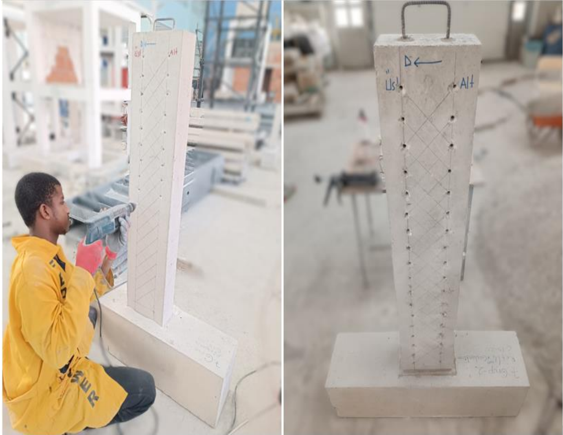
řekil 3.41. Matkap ile deliklerin aılması ve ankraj delikleri aılmış olan kiriř numunesi
