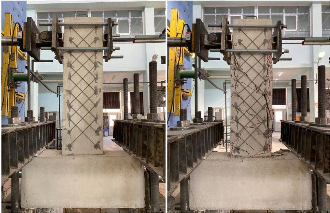
Şekil 4.89. BC15/X3.3-T4-15-45/125-360-0.0-2Ø16/3.3 3 numunesi deney öncesi ve sonrası görünümü
