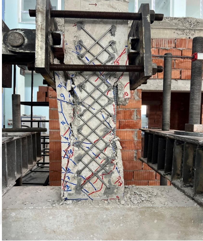
Şekil 4.10. BC20/X3.3-T6-15-45/125-250-0.6-2Ø16/3.3 numunesine ait deney sonu görünümü
