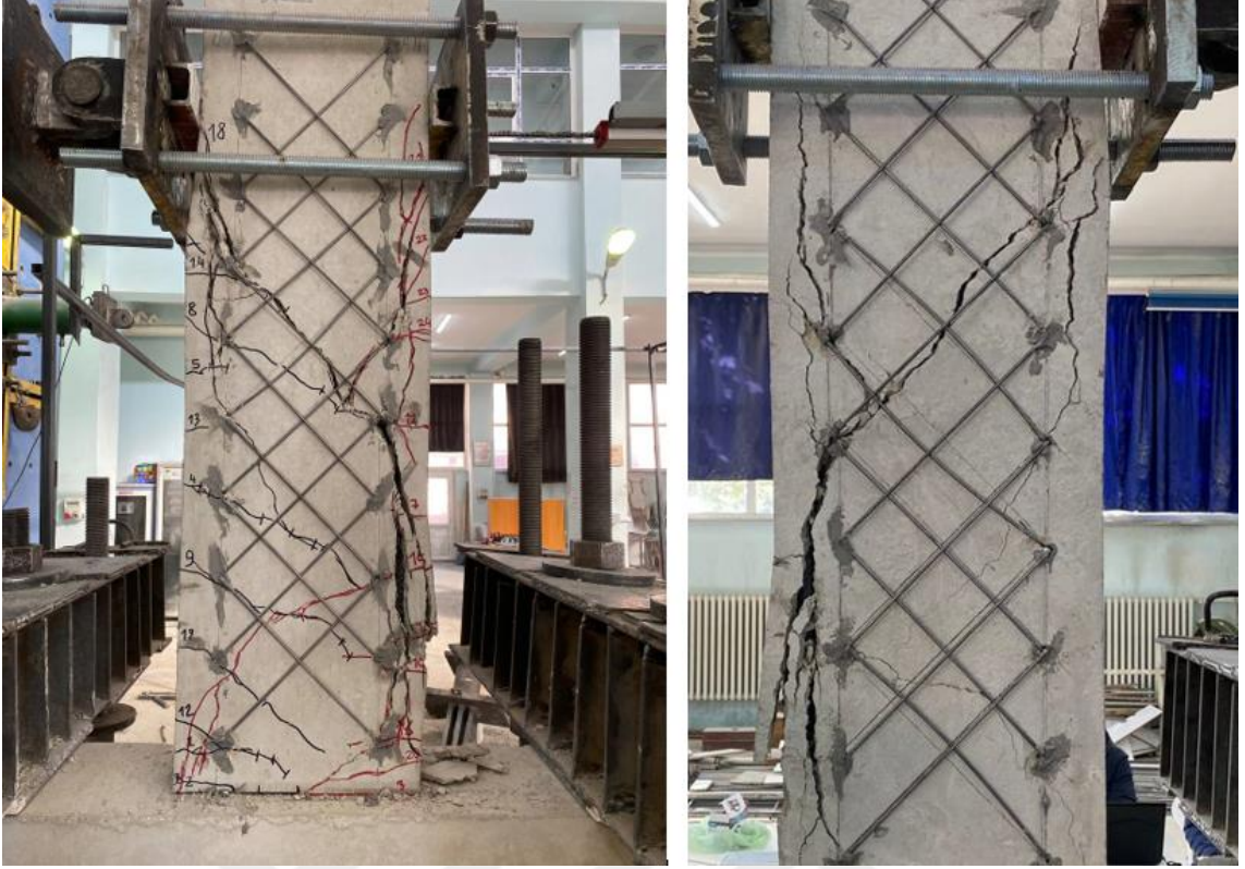
Şekil 4.90. BC15/X3.3-T4-15-45/125-360-0.0-2Ø16/3.3 3 numunesi deney sonu görünümü
