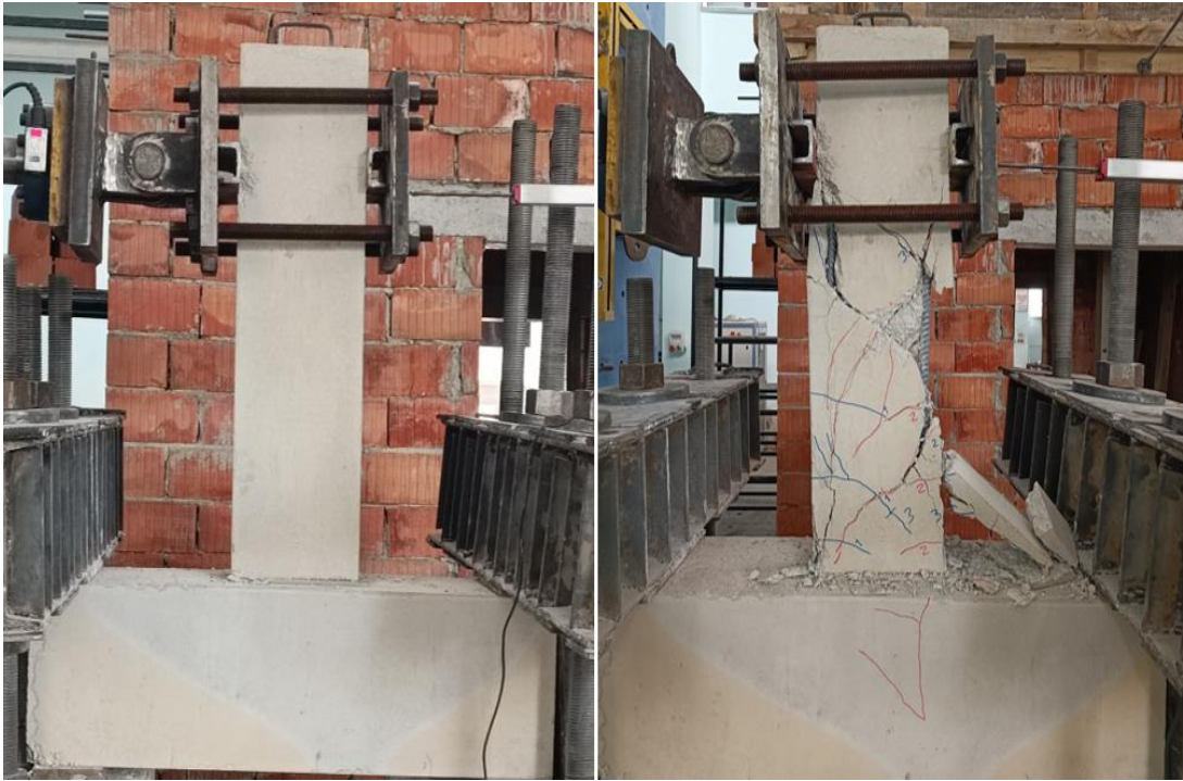
Şekil 4.1. BC20/N0.0-N0-0-0/125-250-0.6-2Ø16/3.3 numunesi deney öncesi ve sonrası görünümü
