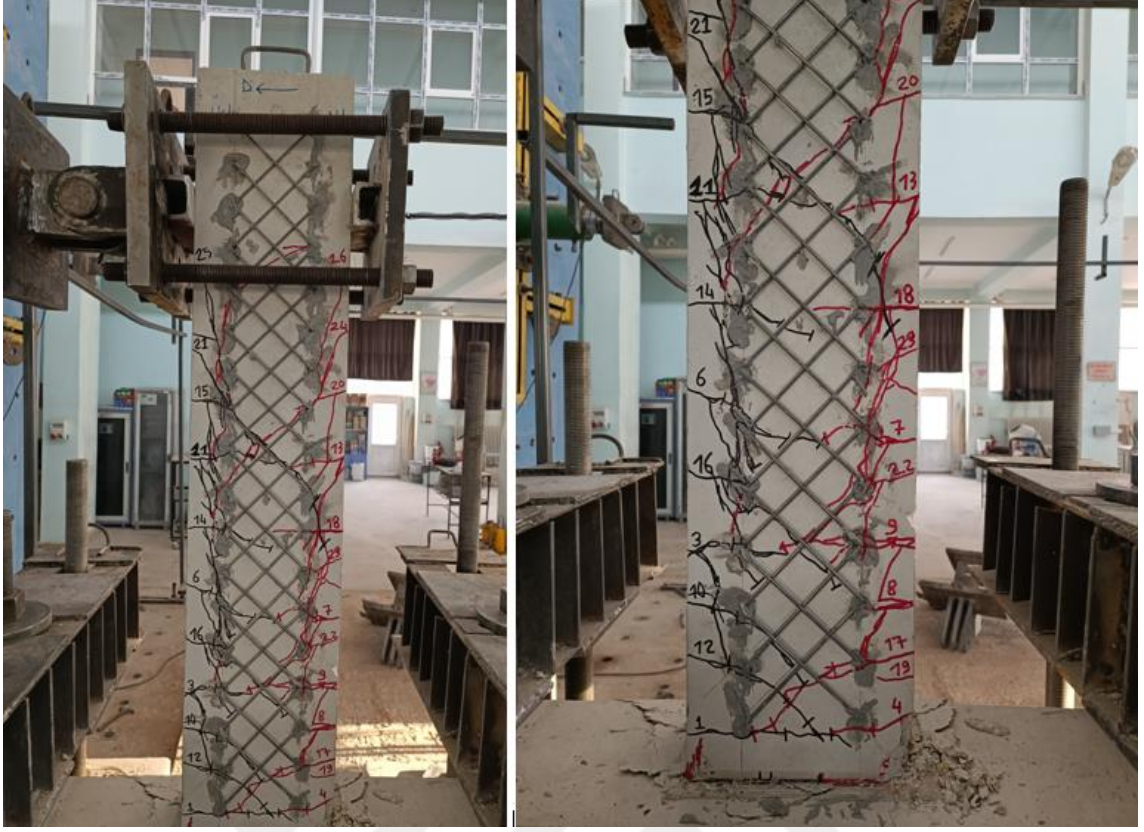
Şekil 4.98. BC15/X3.3-T4-15-45/125-250-0.6-2Ø16/4.9 numunesi deney sonu görünümü
