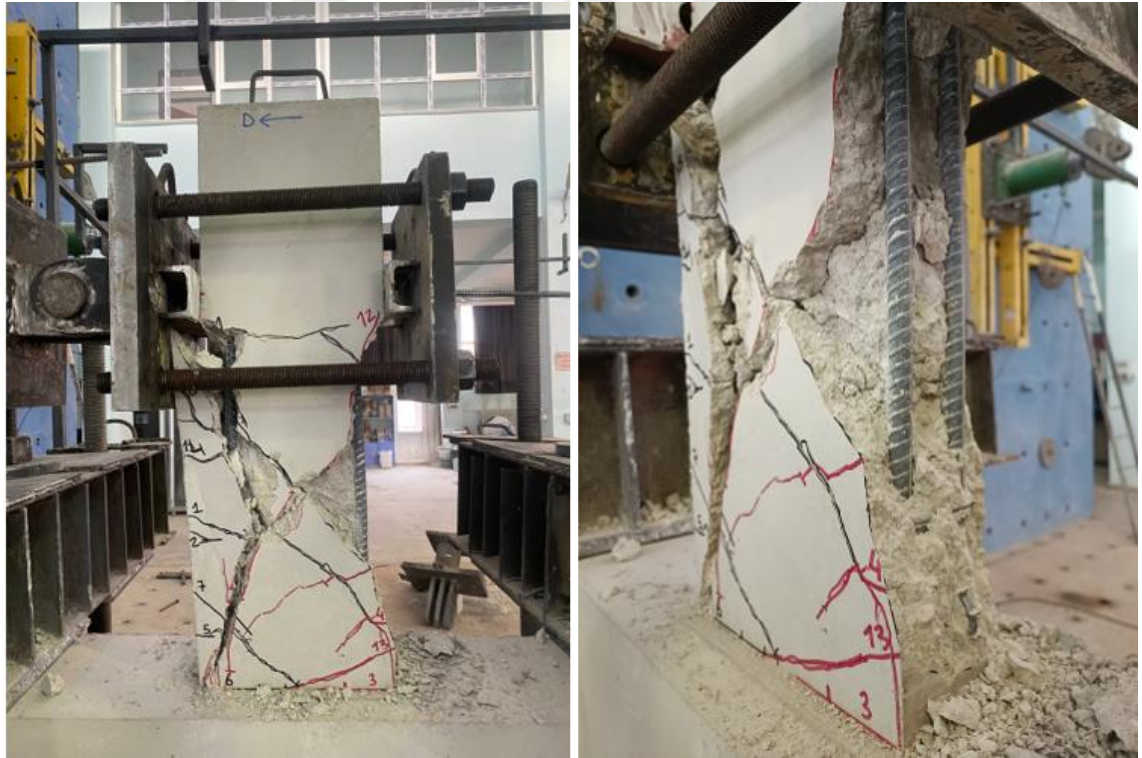
Şekil 4.66. BC15/N0.0-N0-0-0/125-250-0.6-2Ø16/2.5 numunesi deney sonu görünümü
