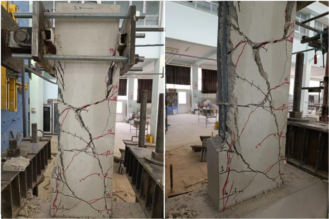
Şekil 4.82. BC15/N0.0-N0-0-0/125-360-0.6-2Ø16/3.3 numunesi deney sonu görünümü
