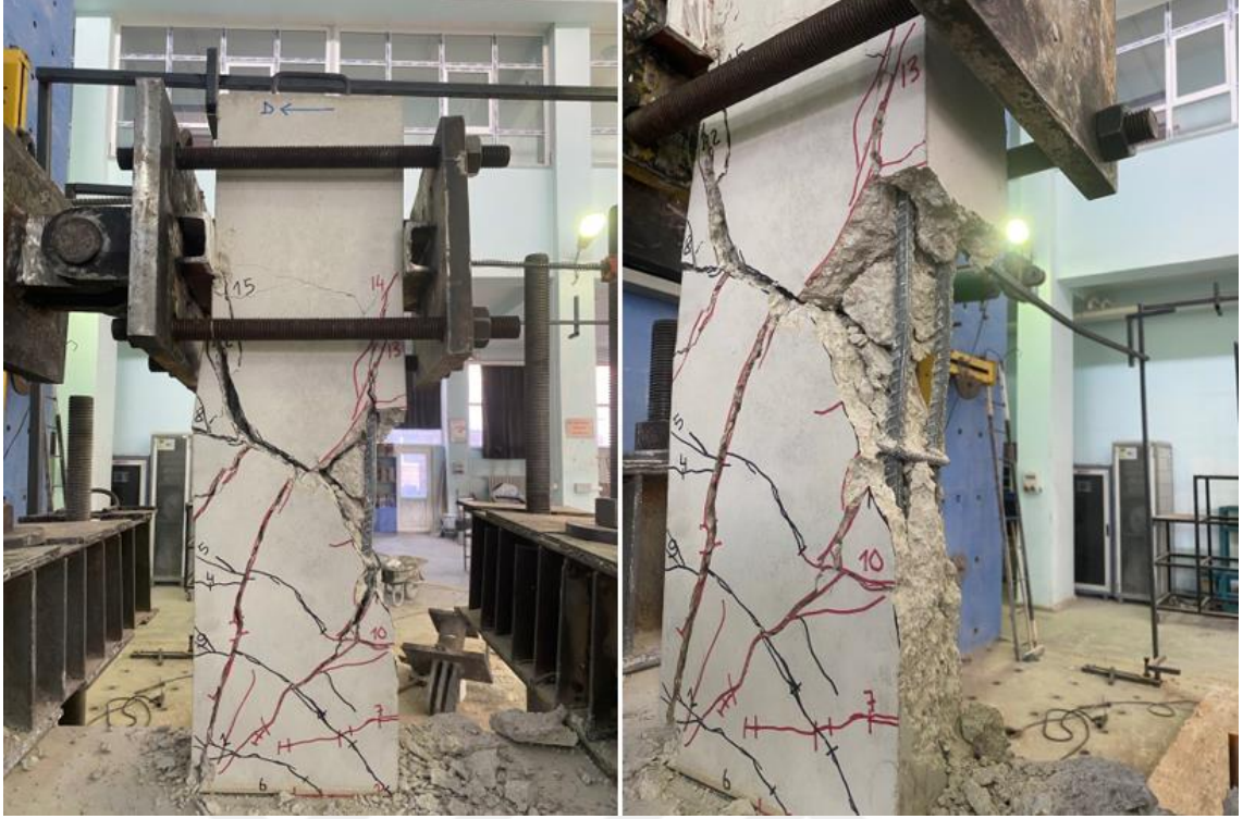
Şekil 4.26. BC15/N0.0-N0-0-0/125-250-0.6-2Ø14/3.3 numunesi deney sonu görünümü
