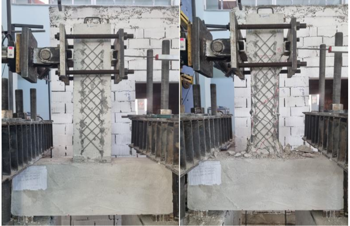
ekil 4.17. BC15/X3.3-T4-15-45/125-250-0.6-2Ø16/3.3 numunesi deney ncesi ve sonrası grnm
