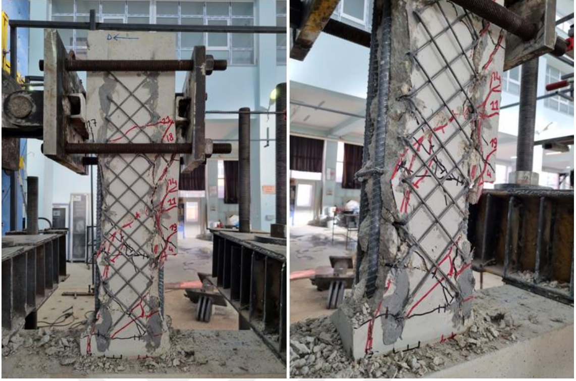
Şekil 4.62. BC20/X3.3-T4-15-45/125-250-0.6-2Ø16/3.3 numunesi deney sonu görünümü
