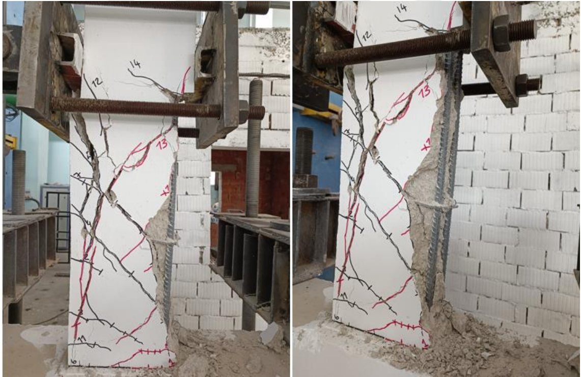
Şekil 4.50. BC10/N0.0-N0.0-0/125-250-0.6-2Ø16/3.3 numunesi deney sonu görünümü
