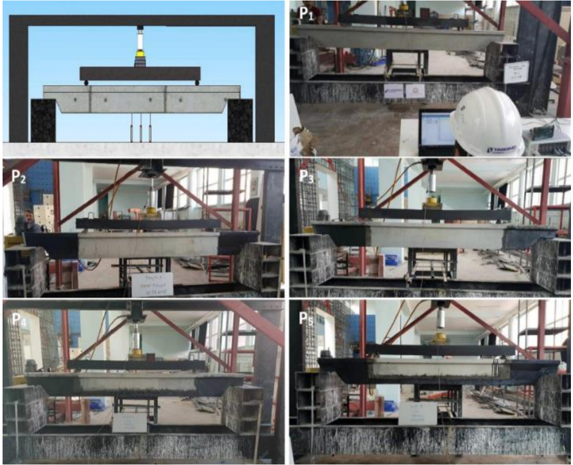
Şekil 2.2. CFRP ile kesme bölgesi güçlendirilen aşıklar ve deney düzeneği (Gemi ve ark., 2019)
