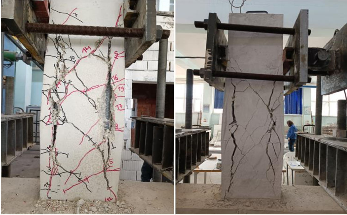
Şekil 4.42. BC5/N0.0-N0-0-0/125-250-0.6-2Ø16/3.3 numunesi deney sonu görünümü
