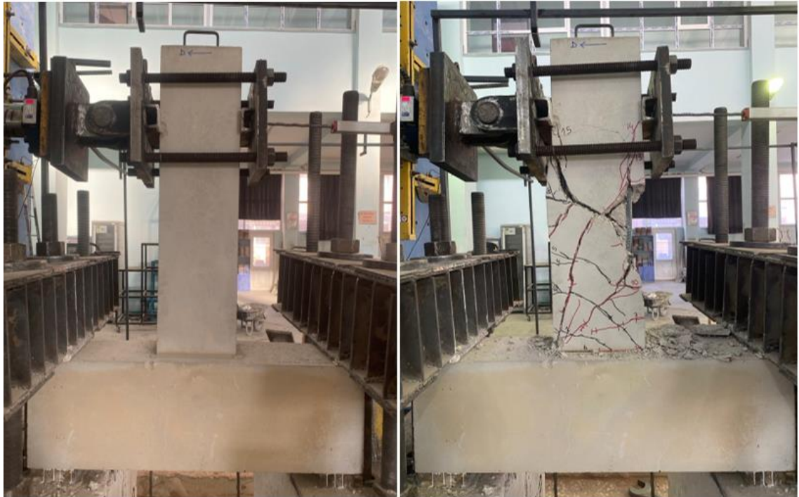
Şekil 4.25. BC15/N0.0-N0-0-0/125-250-0.6-2Ø14/3.3 numunesi deney öncesi ve sonrası görünümü
