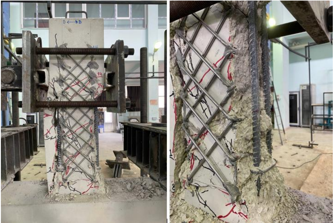
Şekil 4.74. BC15/X3.3-T6-15-45/125-250-0.6-2Ø16/2.5 numunesi deney sonu görünümü
