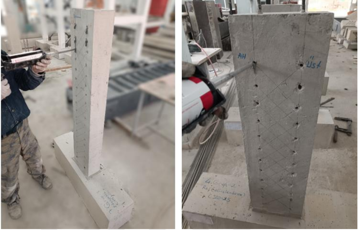
Şekil 3.42. Epoksi tabancası yardımıyla deliklerin epoksi ile doldurulması
