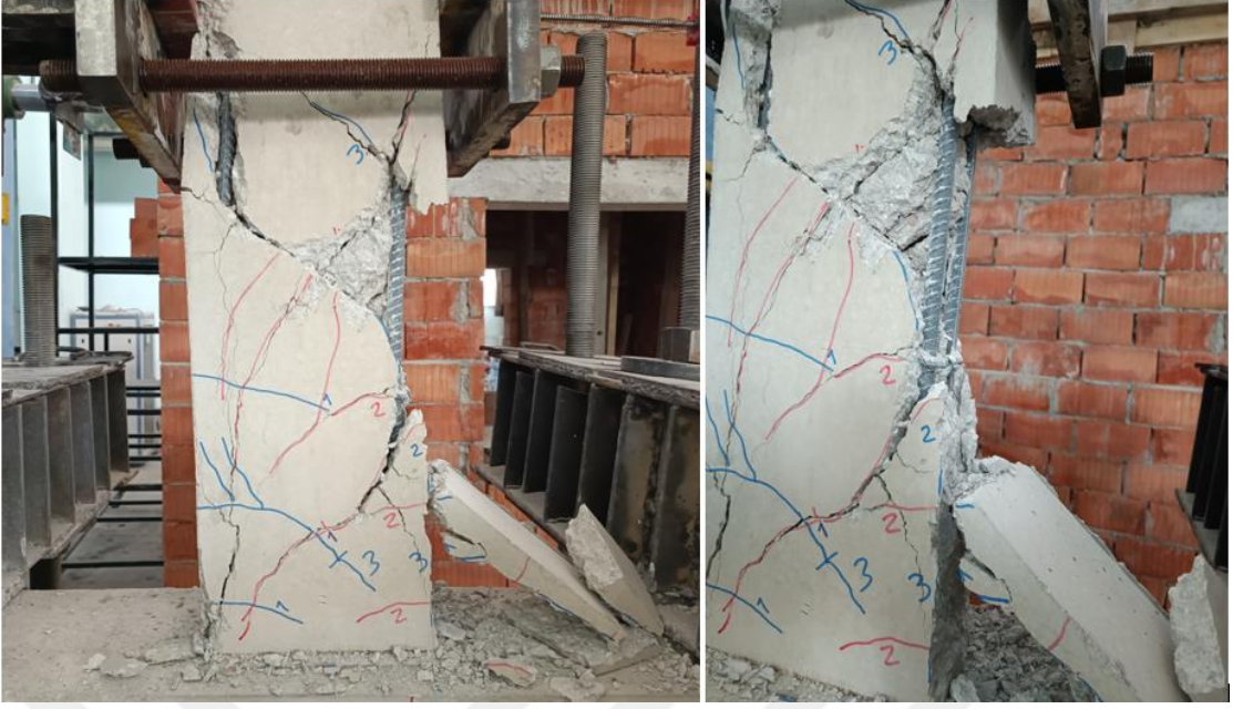
Şekil 4.2. BC20/N0.0-N0-0-0/125-250-0.6-2Ø16/3.3 numunesi deney sonrası detay görünümü
