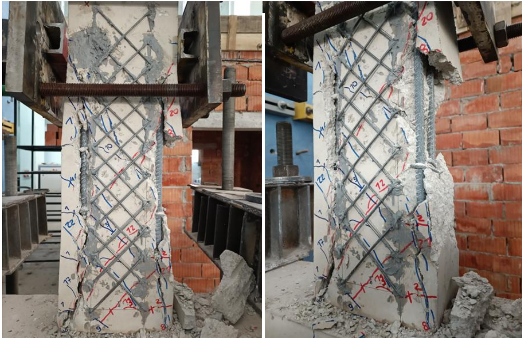
Şekil 4.6. BC20/X3.3-T4-15-45/125-250-0.6-2Ø16/3.3 numunesinin deney sonraki görüntüsü
