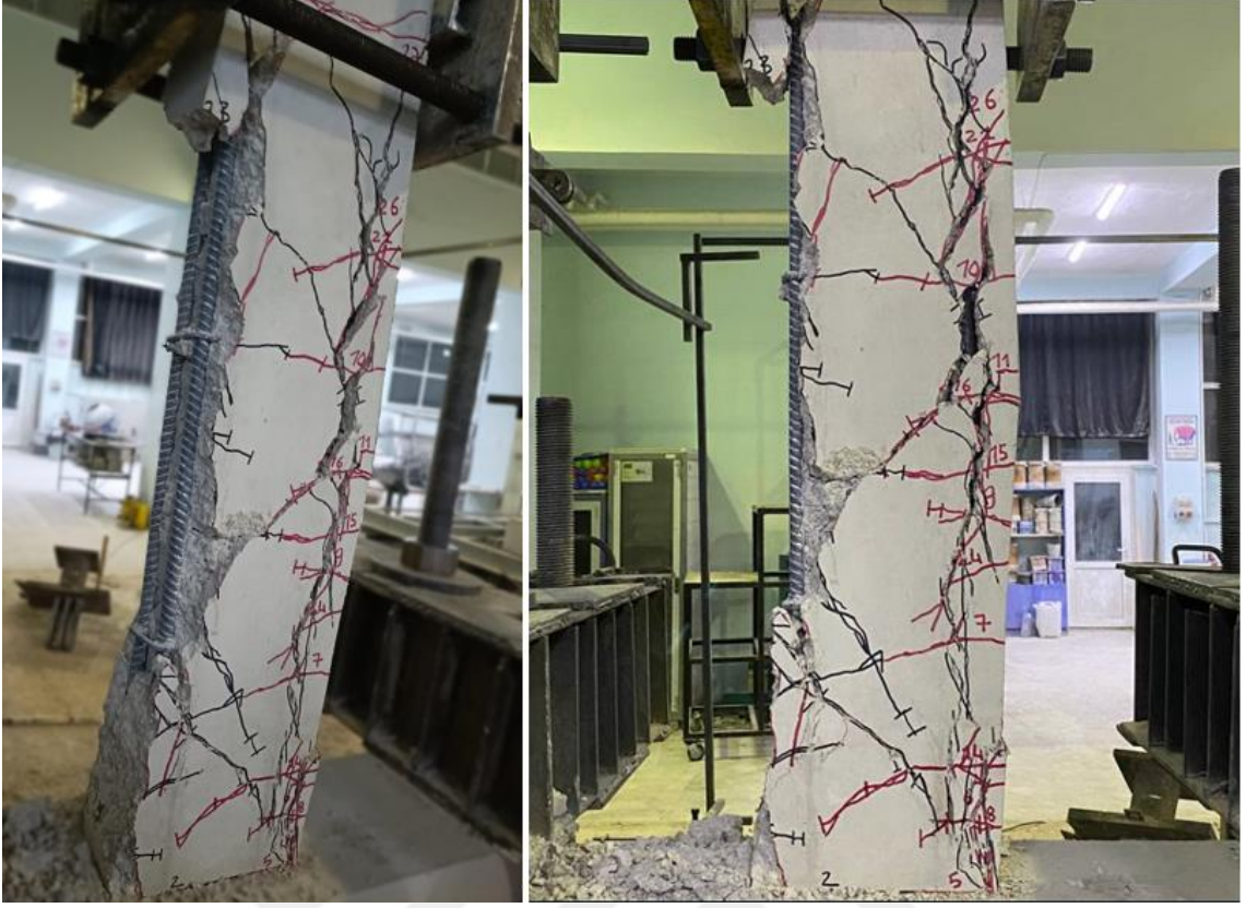
Şekil 4.94. BC15/N0.0-N0-0-0/125-250-0.6-2Ø16/4.9 numunesi deney sonu görünümü
