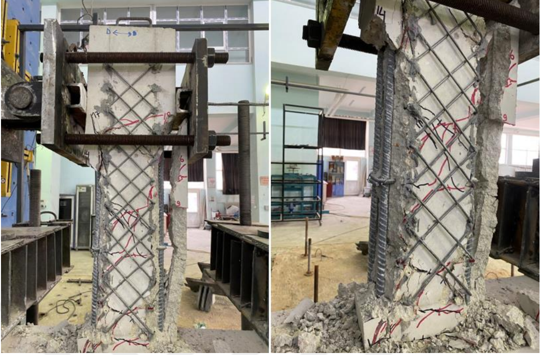
Şekil 4.30. BC15/X3.3-T4-15-45/125-250-0.6-2Ø14/3.3 numunesi deney sonu görünümü
