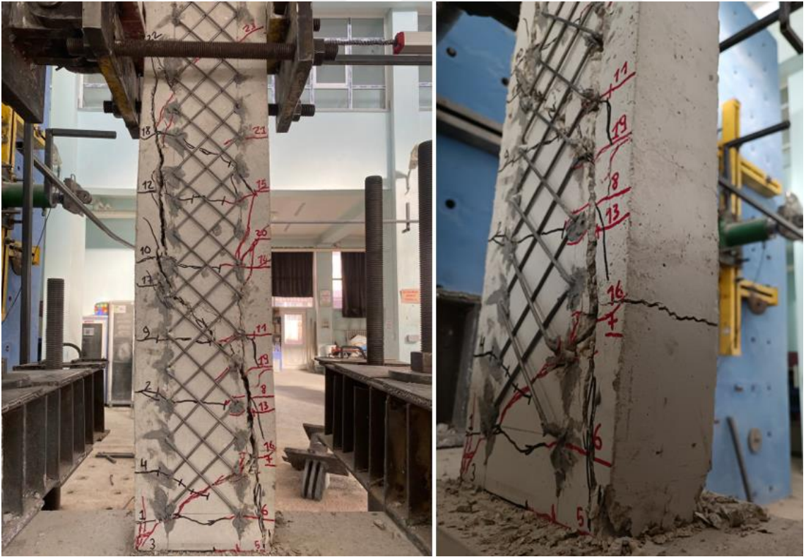
Şekil 4.102. BC15/X3.3-T4-15-45/125-250-0.0-2Ø16/4.9 numunesi deney sonu görünümü
