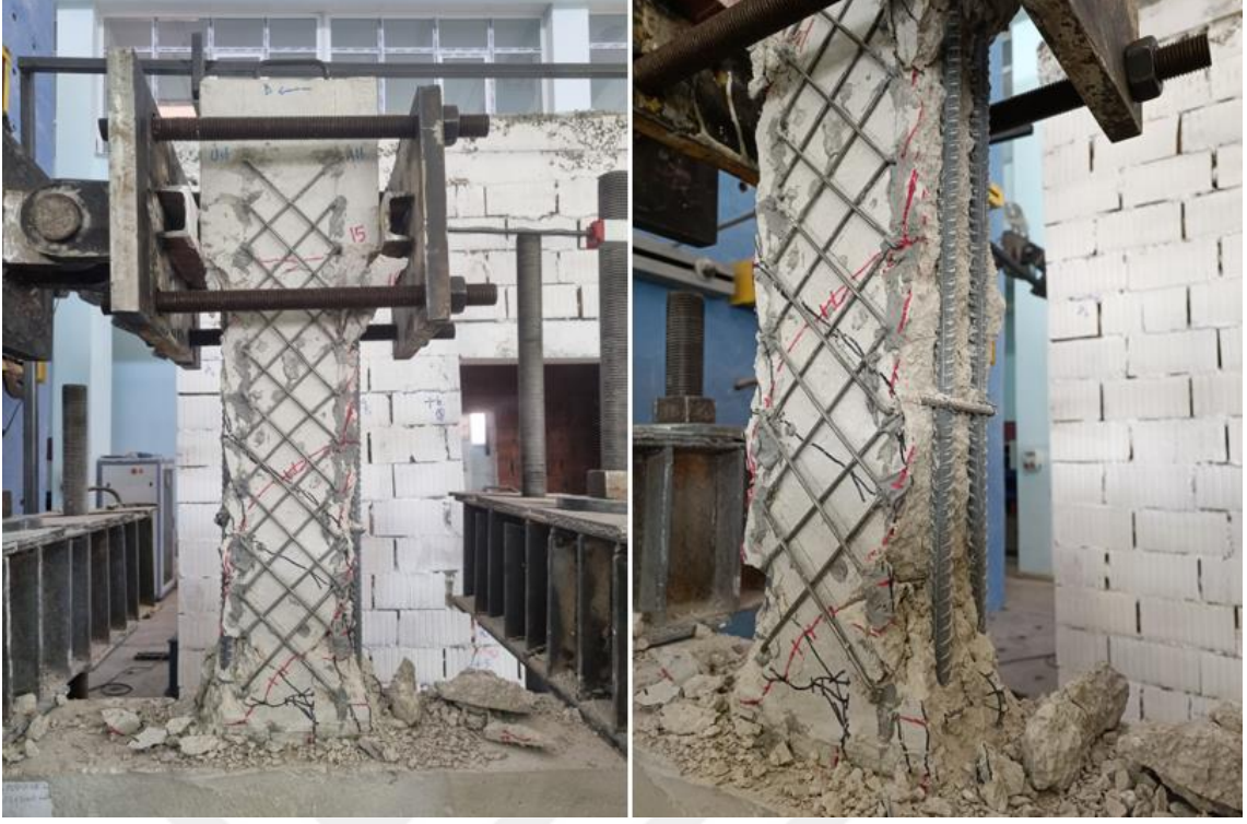
Şekil 4.18. BC15/X3.3-T4-15-45/125-250-0.6-2Ø16/3.3 numunesi deney sonu görünümü
