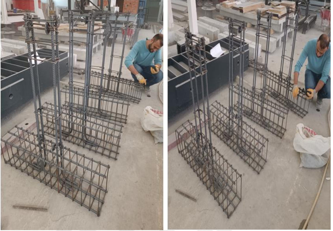
Şekil 3.31. Konsol kirişlerin donatı detayları
