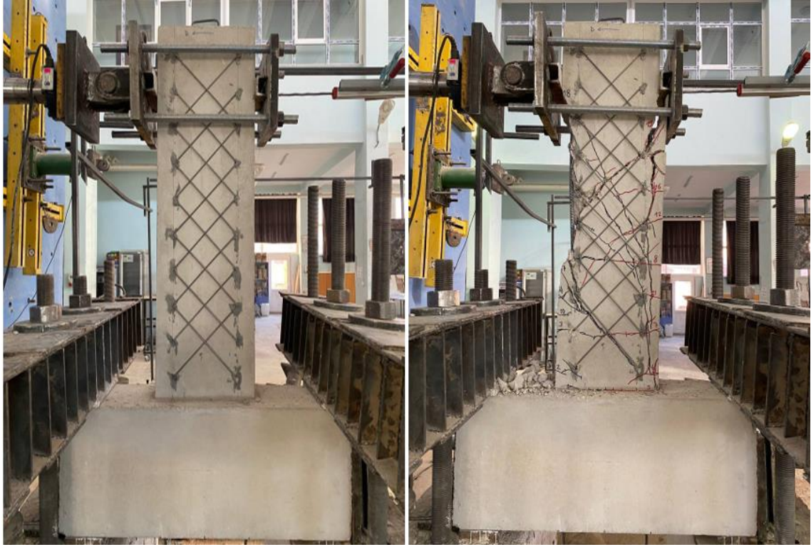
Şekil 4.85. BC15/X3.3-T4-15-45/125-360-0.6-2Ø16/3.3 numunesi deney öncesi ve sonrası görünümü
