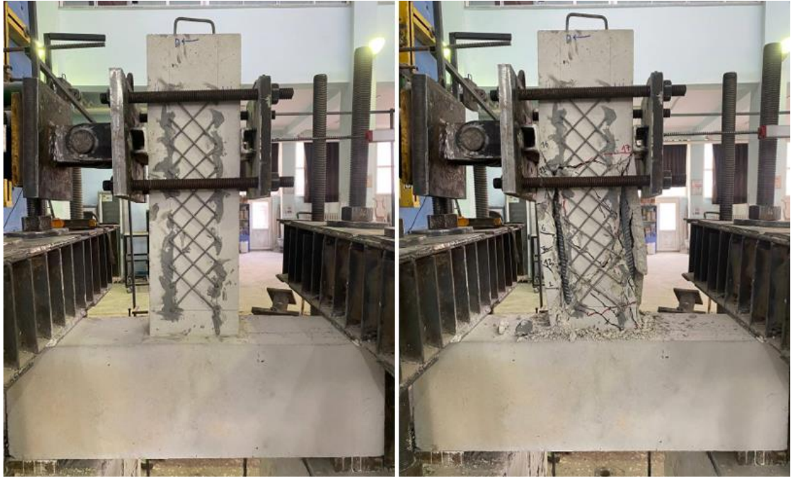
Şekil 4.77. BC15/X3.3-T4-15-45/125-250-0.0-2Ø16/2.5 numunesi deney öncesi ve sonrası görünümü
