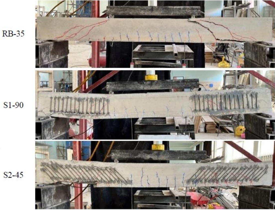
Şekil 2.10. Mekanik dikiş ile güçlendirilmiş kirişlerin (Uysal ve ark., 2022; Baş, 2024)
