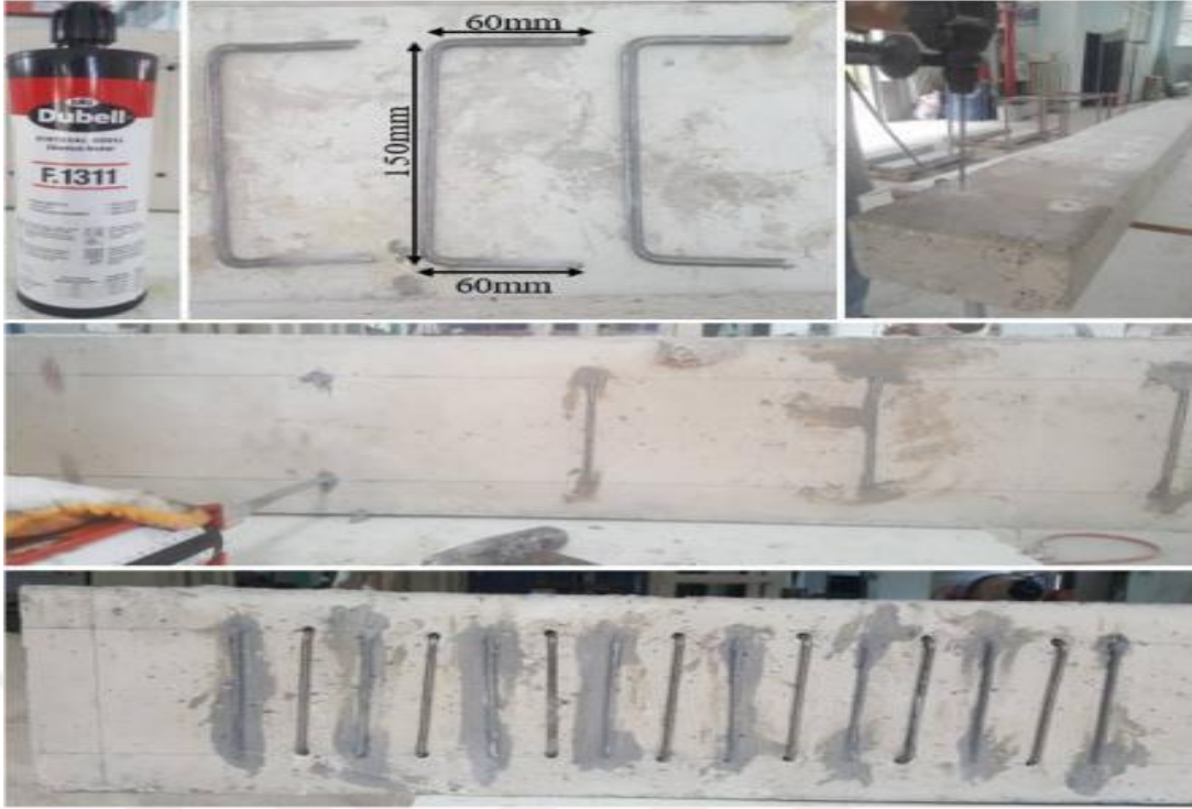
Şekil 2.9. 90° açılı MSS uygulaması (Aksoylu ve ark., 2022)
