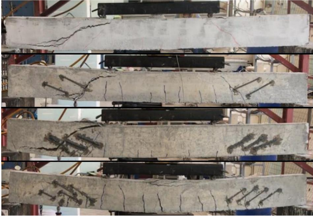
Şekil 2.8. Ön hasarlı kirişlerin dikiş demirleri ile güçlendirilmesi (Alshlash ve ark., 2019; Uysal. 2024)
