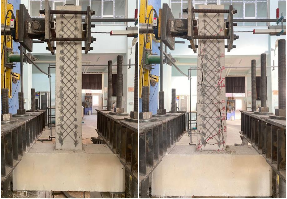
Şekil 4.101. BC15/X3.3-T4-15-45/125-250-0.0-2Ø16/4.9 numunesi deney öncesi ve sonrası görünümü
