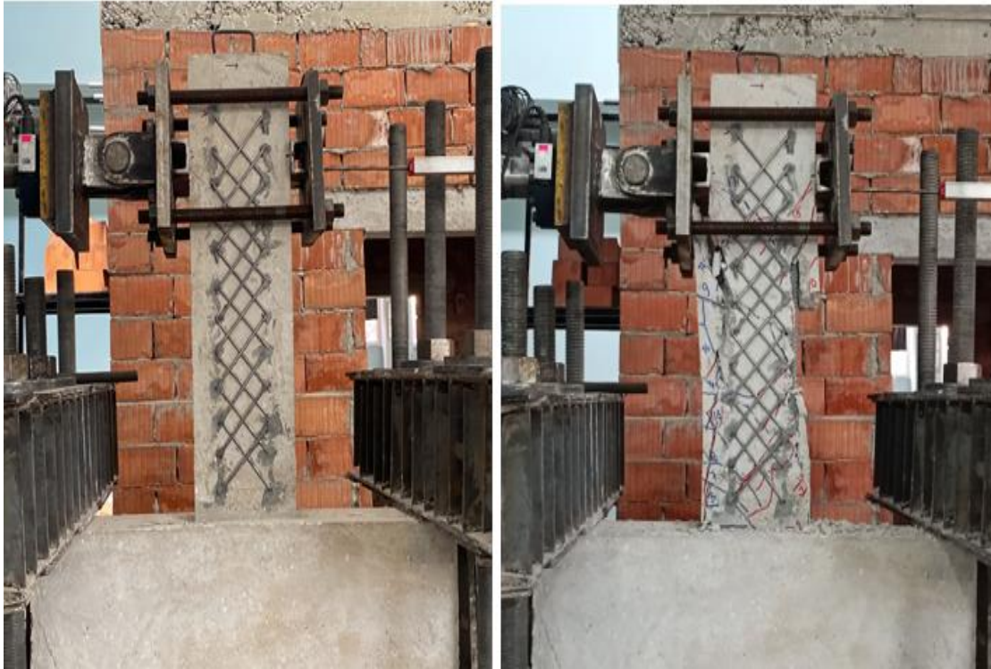
Şekil 4.9. BC20/X3.3-T6-15-45/125-250-0.6-2Ø16/3.3 numunesine ait deney öncesi ve sonrası görünümü
