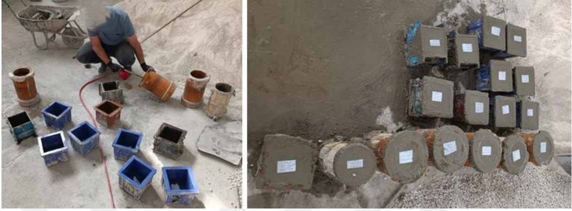
řekil 3.36. Kp ve silindir numunenin yaėlanması ve beton dkm sırasında alınan kp ve silindir numuneler
