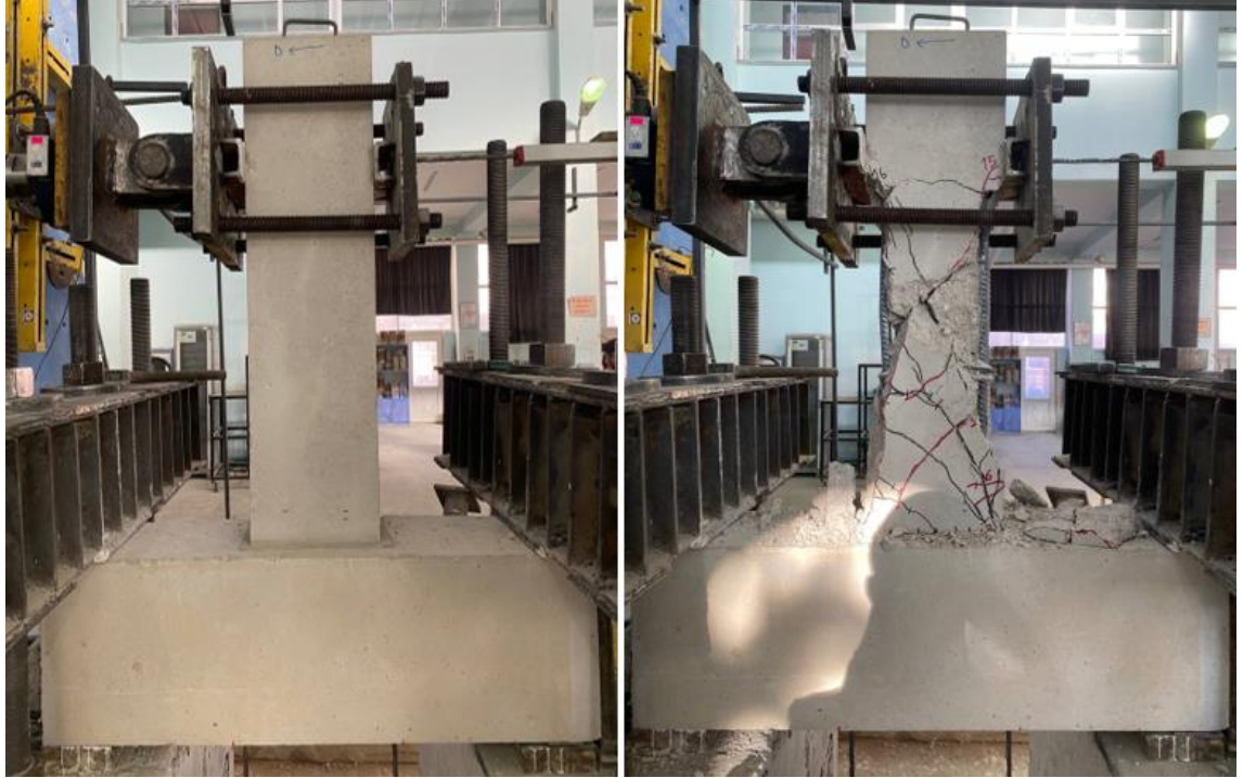
Şekil 4.57. BC20/N0.0-N0-0-0/125-250-0.6-2Ø16/3.3 numunesi deney öncesi ve sonrası görünümü
