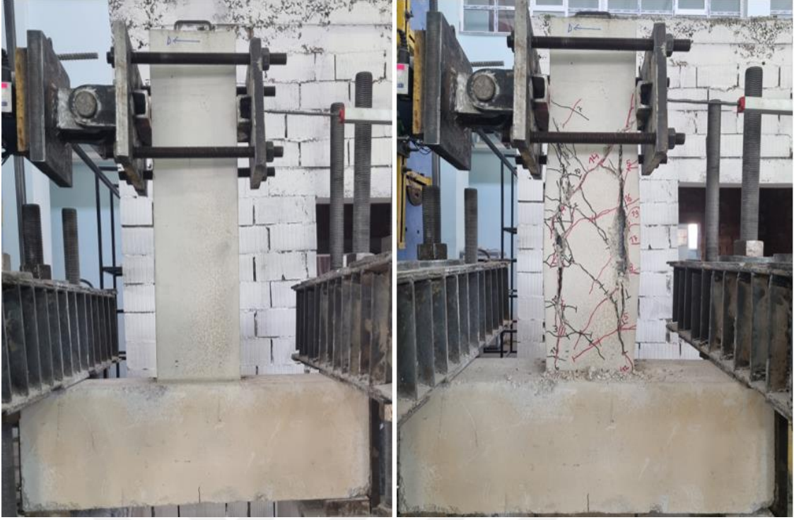
Şekil 4.41. BC5/N0.0-N0-0-0/125-250-0.6-2Ø16/3.3 numunesi deney öncesi ve sonrası görünümü
