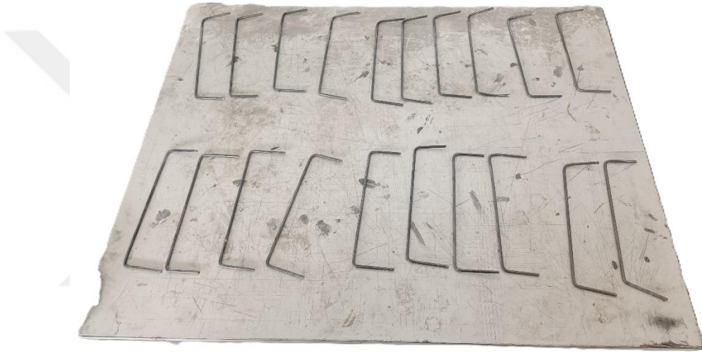
Şekil 3.40. Mekanik çelik dikişler-4mm çaplı
