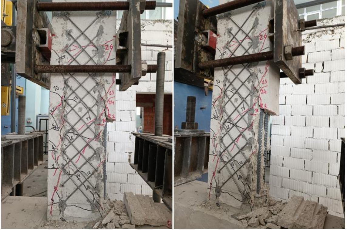
Şekil 4.22. BC15/X3.3-T4-15-45/125-250-0.0-2Ø16/3.3 numunesi deney sonu görünümü
