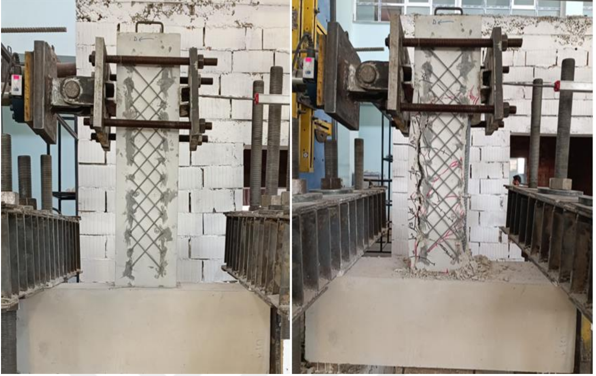
Şekil 4.53. BC10/X3.3-T4-15-45/125-250-0.6-2Ø16/3.3 numunesi deney öncesi ve sonrası görünümü
