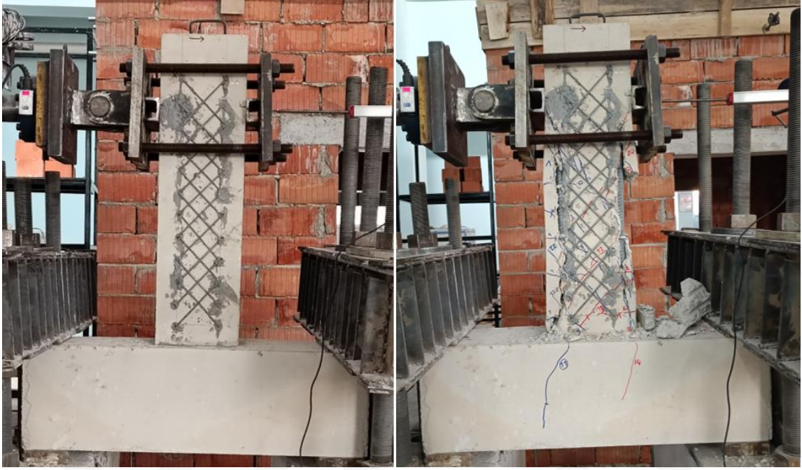
Şekil 4.5. BC20/X3.3-T4-15-45/125-250-0.6-2Ø16/3.3 numunesi deney önceki ve sonraki görüntüsü
