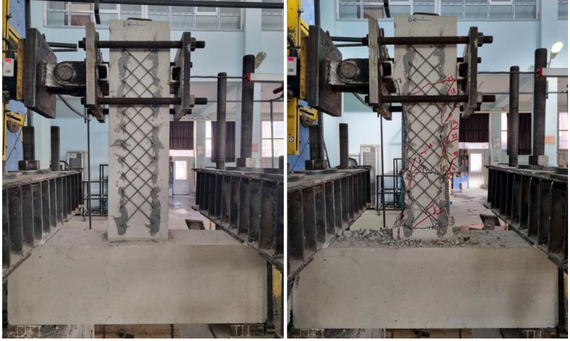
Şekil 4.61. BC20/X3.3-T4-15-45/125-250-0.6-2Ø16/3.3 numunesi deney öncesi ve sonrası görünümü
