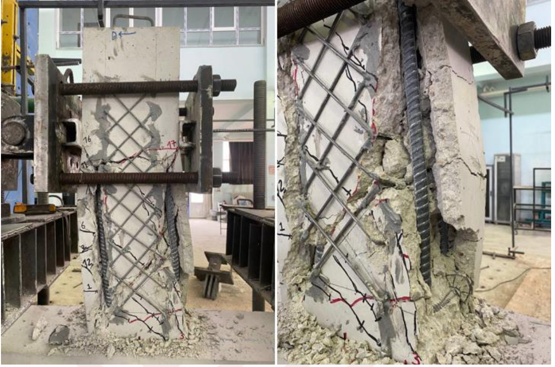
Şekil 4.78. BC15/X3.3-T4-15-45/125-250-0.0-2Ø16/2.5 numunesi deney sonu görünümü
