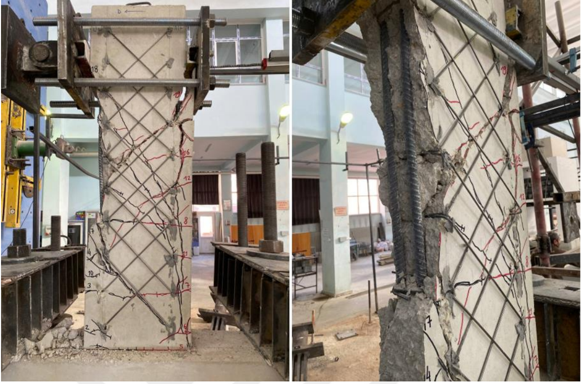
Şekil 4.86. BC15/X3.3-T4-15-45/125-360-0.6-2Ø16/3.3 numunesi deney sonu görünümü
