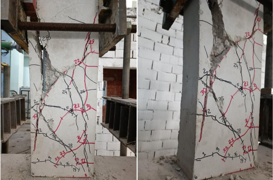
Şekil 4.14. BC15/N0.0-N0-0-0/125-250-0.6-2Ø16/3.3 numunesine ait deney sonu görünümü
