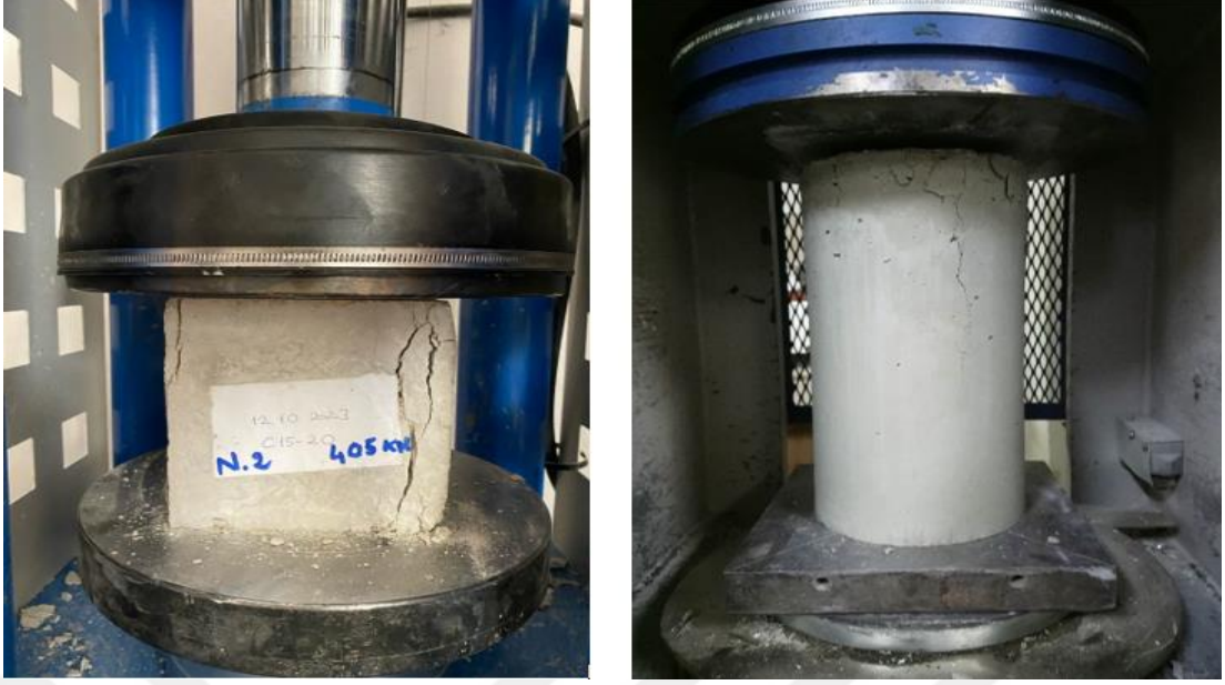
Şekil 3.37. Küp ve silindir numunelerin basınç presinde test edilmesi
