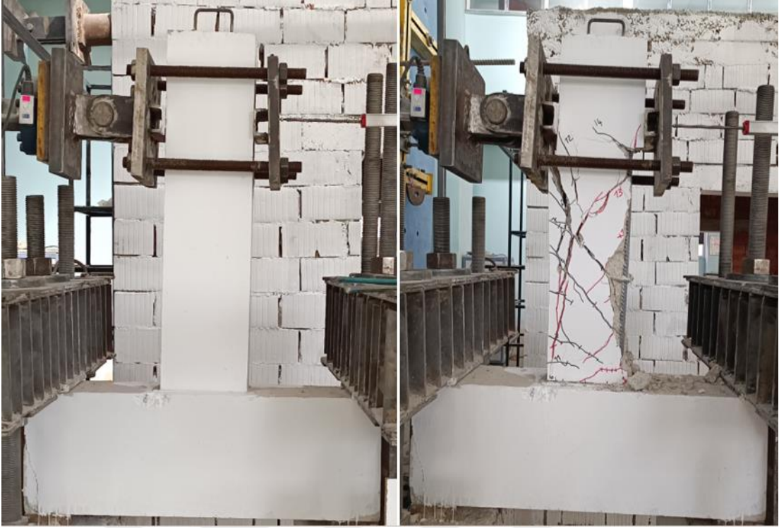
Şekil 4.49. BC10/N0.0-N0.0-0/125-250-0.6-2Ø16/3.3 numunesi deney öncesi ve sonrası görünümü
