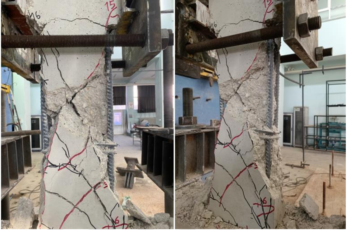
Şekil 4.58. BC20/N0.0-N0-0-0/125-250-0.6-2Ø16/3.3 numunesi deney sonu görünümü
