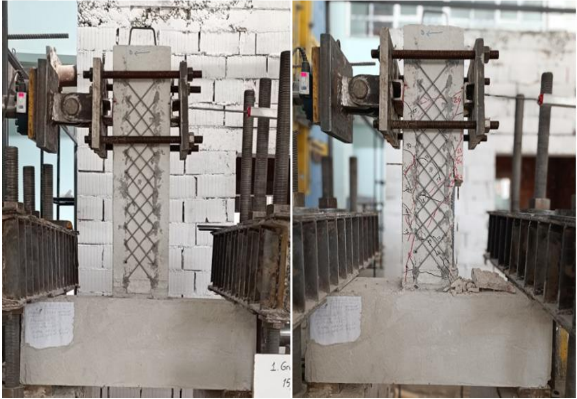
řekil 4.21. BC15/X3.3-T4-15-45/125-250-0.0-2Ø16/3.3 numunesi deney ncesi ve sonrası grnm
