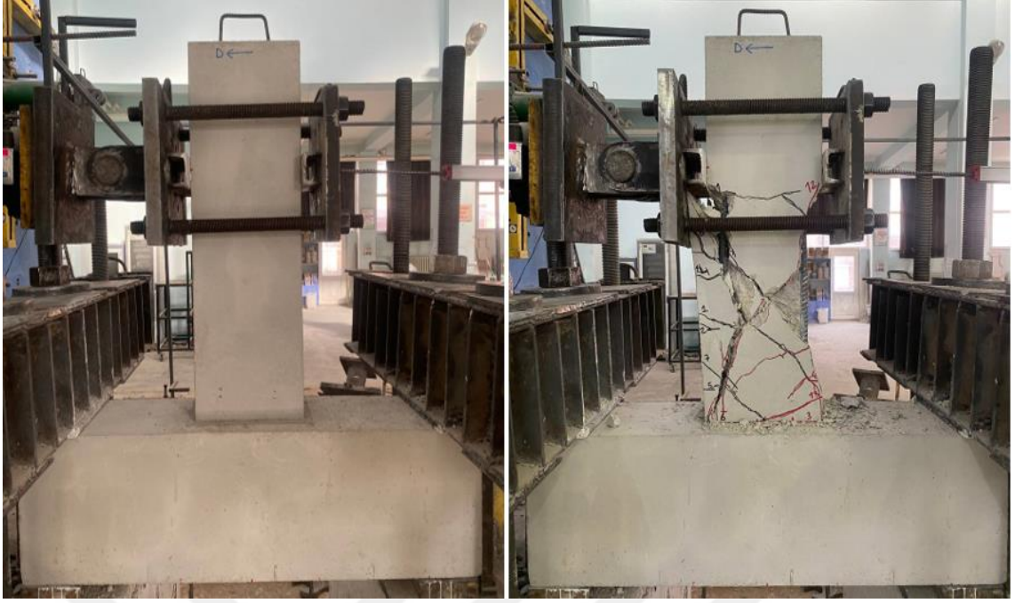
Şekil 4.65. BC15/N0.0-N0-0-0/125-250-0.6-2Ø16/2.5 numunesi deney öncesi ve sonrası görünümü
